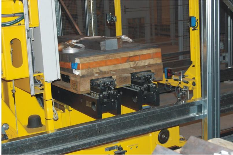
**Abb. 9.10:** Regalbediengerät mit 1to Zuladung
