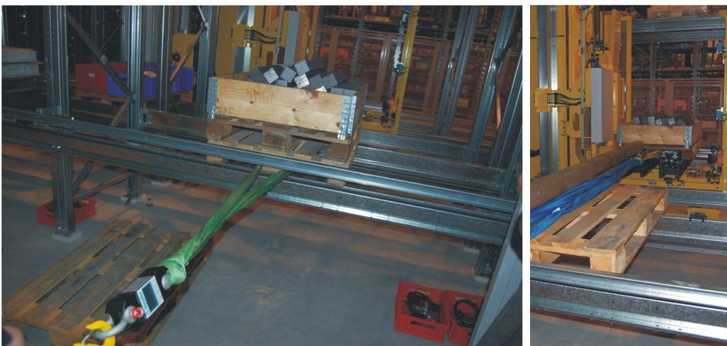
**Abb. 9.12:** Bestimmung der Reibbeiwerte zwischen Palette und Palettenträger sowie zwischen Palette und Teleskopgabeln des Regalbediengerätes
