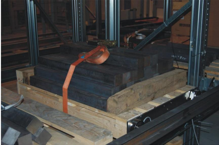
**Abb. 9.8:** Palette mit Stahlkörper (30kg pro Stange) für Anfahrvorgang
