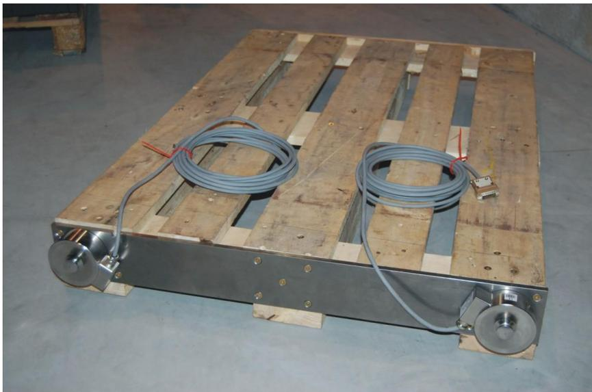
**Abb. 9.5:** Palette mit Kraftmessdosen zur Bestimmung der Kontaktkräfte zwischen Palette und Durchschubsicherung
