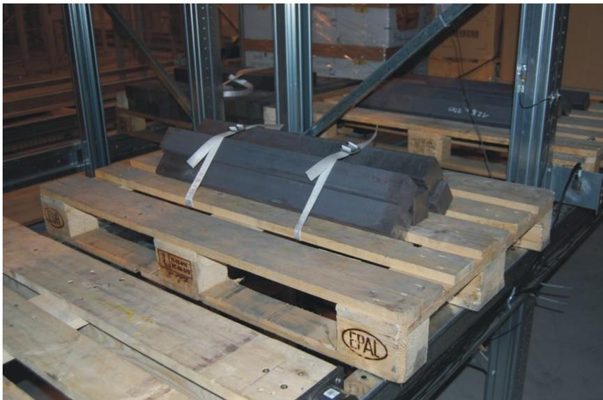
**Abb. 9.9:** Palette mit Stahlkörper im Anfahrfach; Gesamtmasse: 170kg
