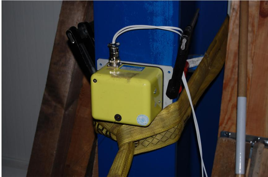
**Abb. 9.6:** Seilzugwegaufnehmer zur Bestimmung der Verformung der Durchschubsicherung
