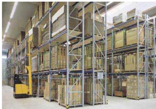
**Abb. 1.2:** Stahlbau eines freistehenden Palettenlagers [Quelle: SSI Schäfer Noell GmbH]
