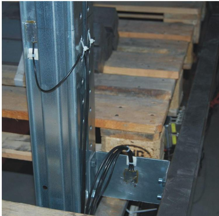
**Abb. 9.3:** Stütze mit Verbindungsblech zur Durchschubsicherung. DMS an der Stütze sowie an beiden Seiten des Verbindungsblechs
