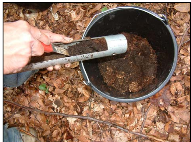
Abb. 5: Stechsonde zur Entnahme der IMIS-Mischproben für organische Auflagen und Mineralböden gemäß den Vorgaben des BMU (2006).
