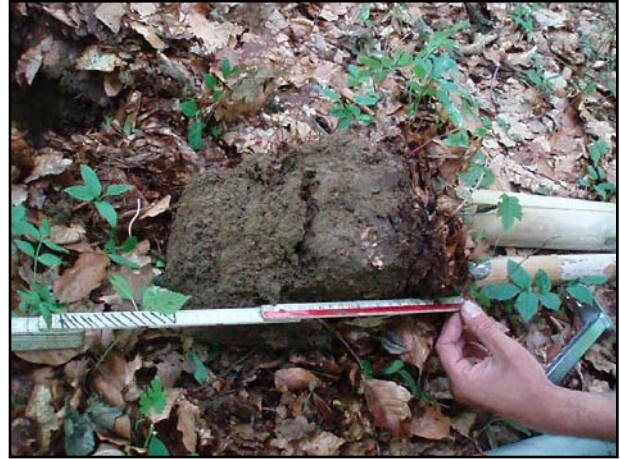
Abb. 4: Entnahme von Bodenmonolithen.
