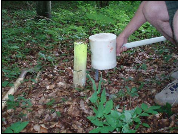
Abb. 3: Markierung der Flächeneckpunkte durch Pfosten und Metallstangen.
