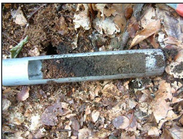
Abb. 5: Stechsonde zur Entnahme der IMIS-Mischproben für organische Auflagen und Mineralböden gemäß den Vorgaben des BMU (2006).
