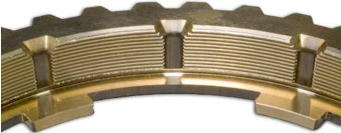
**Bild 8:** Gewinde und Axialnutungen der Messing-Synchronisierung (RP3)
