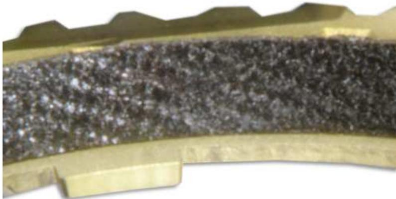
**Bild 9:** RP4 – Carbon-Reibbelag DCA auf Messing-Synchronring (RP4)
