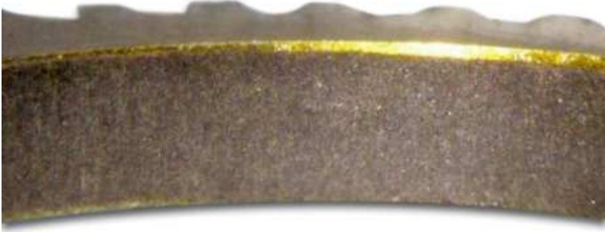
**Bild 11:** RP6 – Synchronring mit Carbonreibbelag HC100 (RP6)
