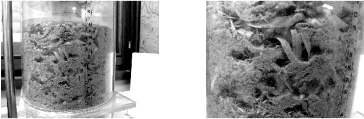
Abbildung 5-9 Hohlräume innerhalb der Matrix des FES durch agglomerierten Faserstoff
