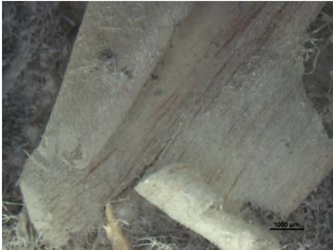
Abbildung 5-76 Variante II; Frässpäne und Altpapierfasern ohne Bewuchs (7,5-fach vergrößert)
