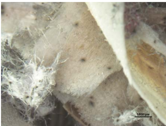
Abbildung 5-75 Variante I mit Schimmelpilzbewuchs, Ascomata von Chaetomium globosum (7,5-fach vergrößert)
