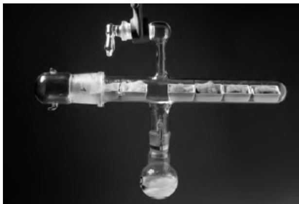
Abbildung 4-28 Glasröhre mit Proben und angeschlossenen Glaskolben mit gesättigter Salzlösung (SCHOLZ 2000)
