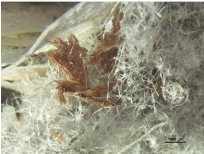
Abbildung 5-77 Variante III; Altpapierfasern ohne Bewuchs (7,5-fach vergrößert)
