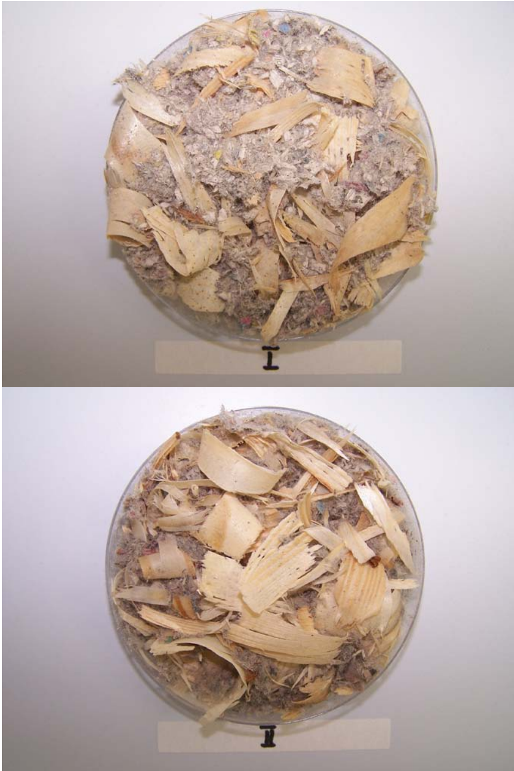
Abbildung 5-72 Probenkörper nach 28 Tagen Inkubationszeit; Variante I (oben): deutlicher Bewuchs, Variante II (unten): kein Bewuchs feststellbar
