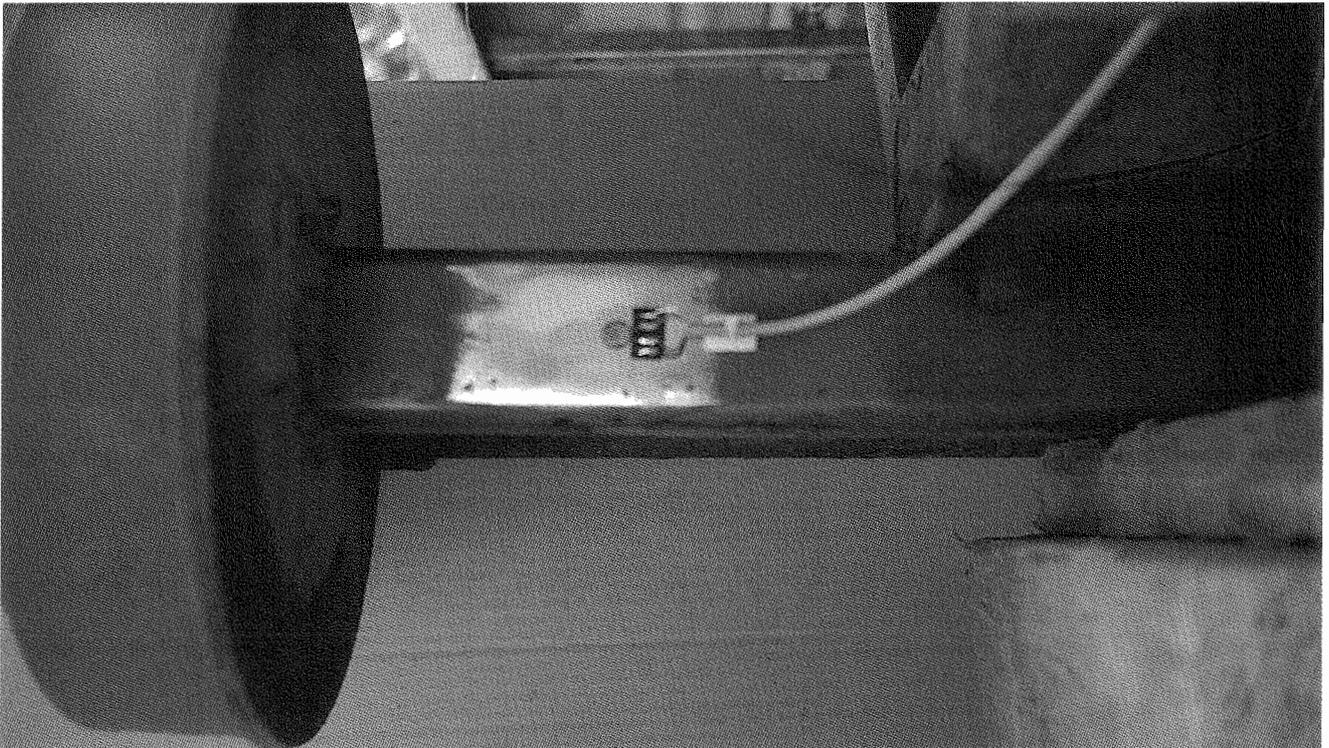
Abbildung 24: DMS- Applikation auf der Achse (Scherspannung).
