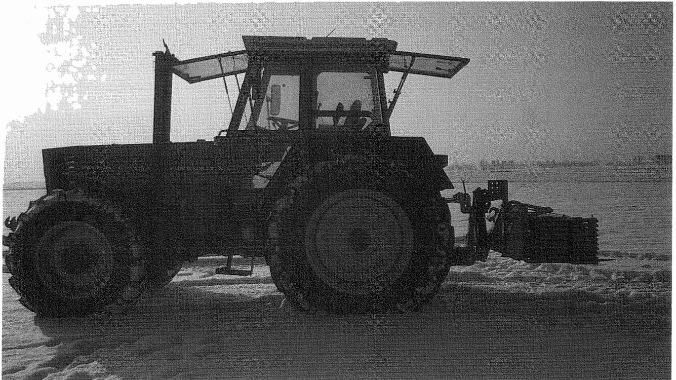
Abbildung 76: Dynamische Messungen am 121-kW-Schlepper mit 2000 kg Last.
