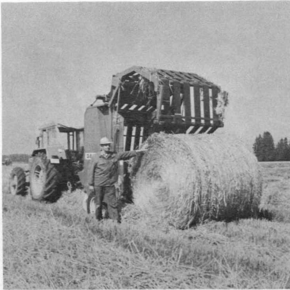
Abb. 7: Bei Rundballenpressen nach dem amerikanischen Prinzip läßt sich der Ballendurchmesser variieren.
