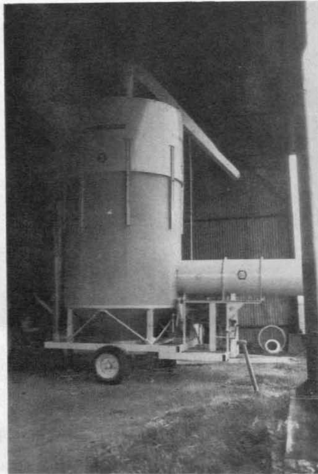
Abb. 4: Umlauf-Satztrockner. Da der Mais ständig in Bewegung bleibt, wird ein schneller Trocknungsverlauf erzielt
