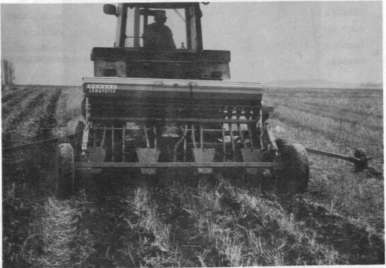
Abb. 4: Maissaat in unbearbeiteten Boden (Weizenstoppel des Vorjahres) mittels eines Sämavators (ein Teil der Fräswerkzeuge wurde ausgebaut)
