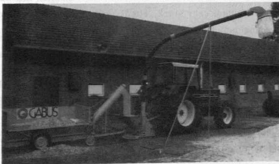
Abb. 7: Schlepperbetriebene Maismühle mit Dosierstation
