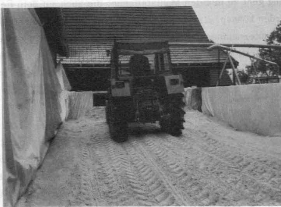
Abb. 9: Sorgfältiges Walzen und Planieren ist bei der Einlagerung von CCM in Flachsilos wichtig
