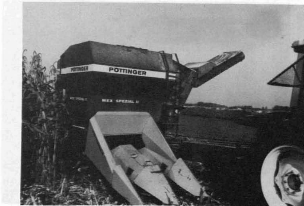
Abb. 3: CCM-Ernter mit zweireihigem Pflückvorsatz und eingebauter Maismühle
