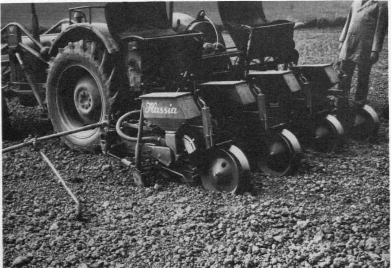
Abb. 8: 4-reihiges Maissägerät mit aufgebauter Getreidesämaschine zur Einsaat einer Getreidereihe nach jeder Maisreihe
