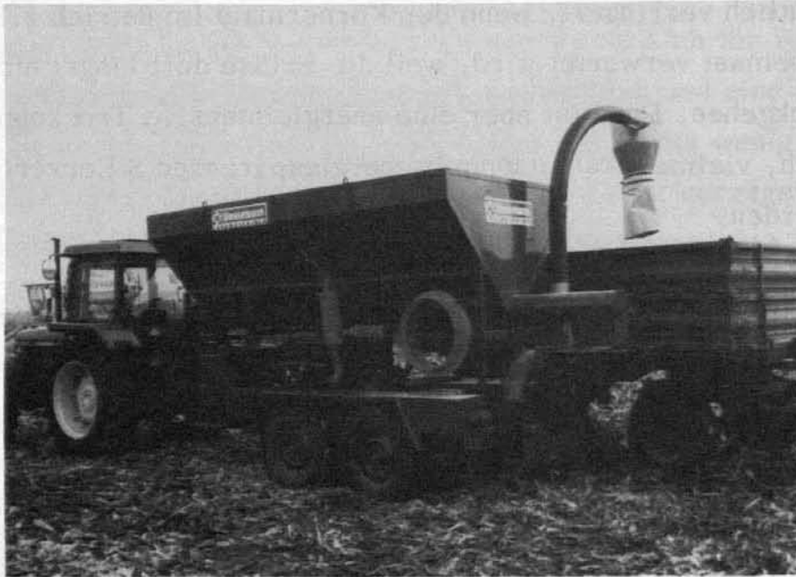
Abb. 8: Fahrbares Mahlaggregat mit Aufbaumotor für den Einsatz auf dem Acker
