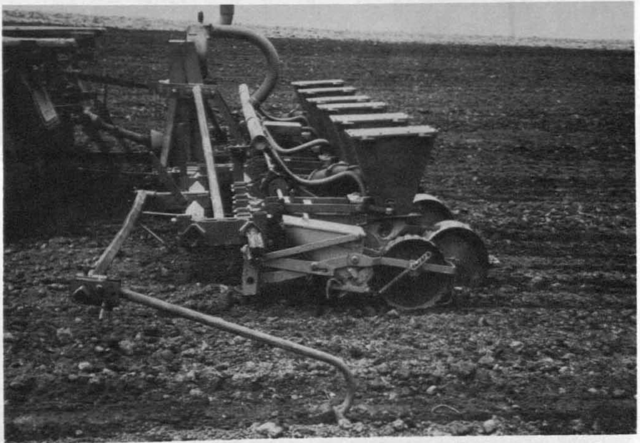
Abb. 7: 6-reihiges Maissäegerät mit seitlich angebautem Rübensägerät zur Einsaat einer Getreidereihe
