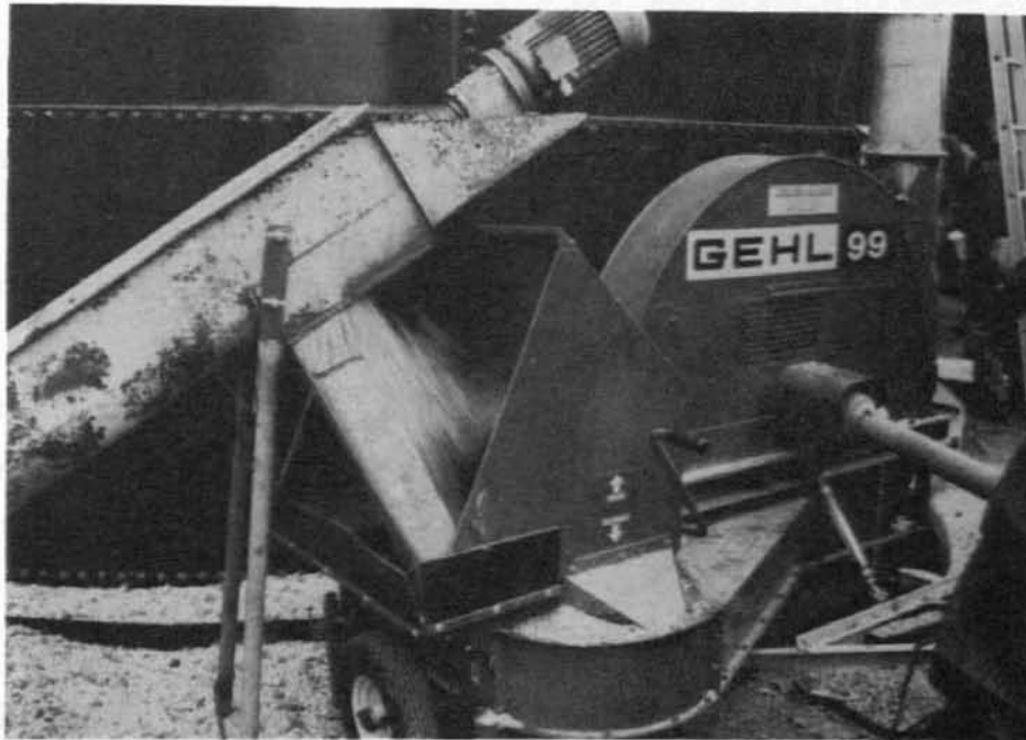
Abb. 10: Die Befüllung von Hochsilos mit CCM erfolgt mit leistungsfähigen schleppergetriebenen Gebläsen
