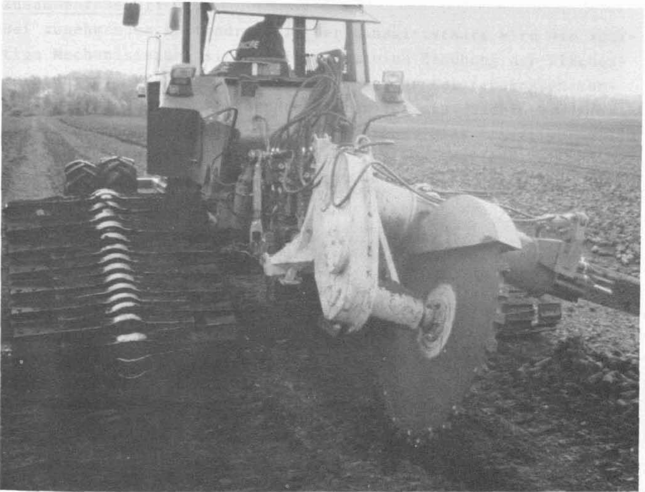
Bild 23: Hydraulische Fernbedienung von Anbaugeräten durch das geöffnete Heckfenster
