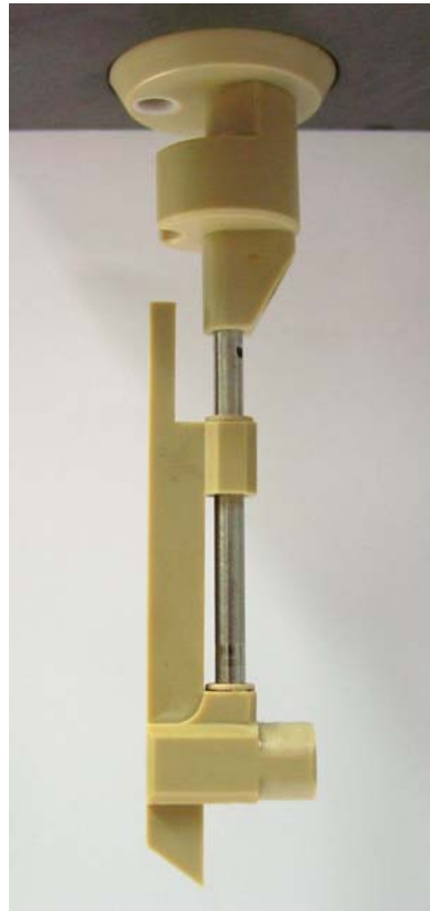
Abb. 5.21: An die Sterilabdeckung des Bioreaktorblocks montiertes Paddelrührorgan.
