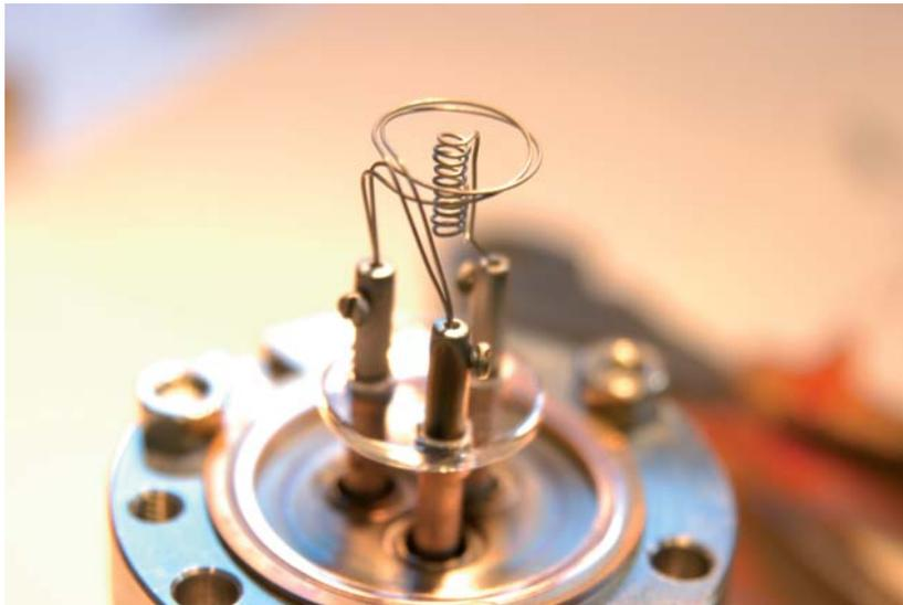
Abbildung 2.8: Fotografie der Elektroden in der Ionenquelle IQ1 (Beschreibung im Text).
