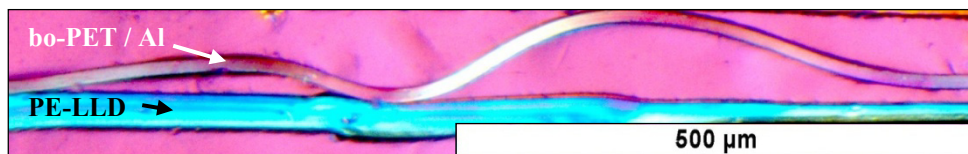
Bild 57: Mikrotomschnitt durch eine Schadstelle: Delamination der Schichten (bo-PET / Al / PE-LLD)
