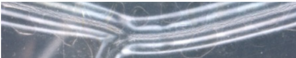
Bild 66: Lichtmikroskopische Aufnahme typischer Risse und Strukturen einer Knickbruchlinie
