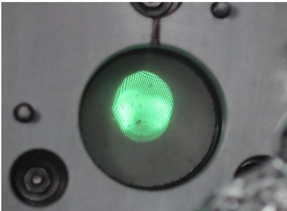
Abbildung 2.4: Bild des Strahlprofils auf dem Leuchtschirm auf dem Probenmanipulator. Die einzelnen Kanäle der Mikrokanalplatte sind deutlich zu sehen.
