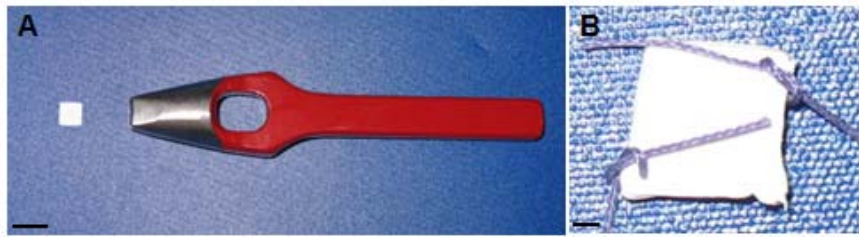
Abbildung 4.8. Locheisen und quadratisch ausgestanzter Zellträger. Zellträger wurden mittels eines Locheisens von 7,5 mm x 7,5 mm, zur Besiedlung im 24-Well-Format und anschließender mechanischer Belastung in einem Bioreaktor, ausgestanzt (A). Zur Befestigung im Bioreaktor wurden die Zellträger mit chirurgischem Nahtmaterial versehen (B). Maßstabsbalken: A = 1 cm, B = 1 mm.
