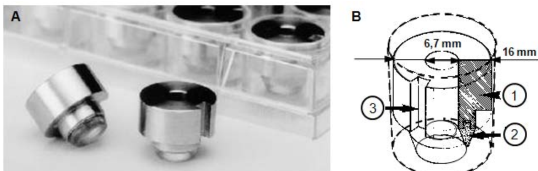
Abbildung 4.9. Edelstahl-Silikon-Einsätze („Fences“) zur reproduzierbaren Besiedlung von 7,5 mm x 7,5 mm Zellträgern in 24-Well Zellkulturplatten (A). Schematische Darstellung eines aus Edelstahl (1) gefertigten Fence mit 16 mm Außen- bzw. 6,7 mm Innendurchmesser und Silikonabdichtung (2) sowie einer Füllrinne (3) [modifiziert von aix-scientifics.de] (B). Die Befüllung des Wells mit Medium über die Füllrinne verhindert ein Flüssigkeitsgefälle zwischen dem Fence und dem umgebenden Well.
