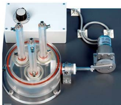
Abbildung 5.19. Prototyp des Bioreaktors der 3. Generation. Durch die parallele mechanische Belastung von drei Zellträgern werden Direktvergleiche unter identischer Belastung gewährleistet. Die Fertigung der Kerneinheit des Bioreaktors aus Plexiglas ermöglicht eine makroskopische Beobachtung der Vorgänge im Inneren. Maßstabsbalken = 2 cm.
