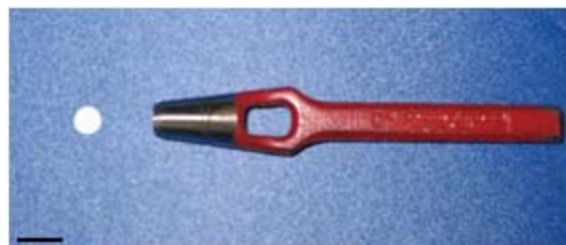
Abbildung 4.6. Locheisen und rund ausgestanzter Zellträger. Zellträger wurden mittels eines Locheisens von 6 mm Durchmesser, zur Besiedelung und Analytik im 96-Well-Format ausgestanzt.
