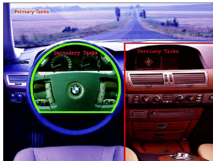
Abbildung 2.4: Platzierung der Bedienelemente im Fahrzeugcockpit entsprechend ihrer Zugehörigkeit zu primärer (blau), sekundärer (grün) und tertiärer (rot) Fahraufgabe [230].
