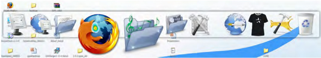
Abbildung 7.6: Screenshot der GazeRocket Benutzeroberfläche. Sobald sich der Blick über die Startleiste bewegt, werden die Inhalte um den aktuellen Blickpunkt (hier: der Nutzer fixiert das Firefox Icon) vergrößert dargestellt.
