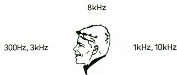
Abbildung 5.21: Ein schmalbandiger 8kHz-Ton wird unabhängig vom Ort der Schallquelle als von oben kommend lokalisiert. Entnommen aus [81].
