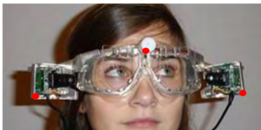
(a) EyeSeeCam mit LEDs (rote Punkte).
