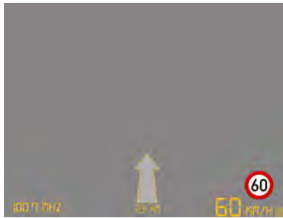
Abbildung 5.4: GUI des HUD mit Geschwindigkeitsanzeige, Navigationspfeil und Radiofrequenzanzeige.
