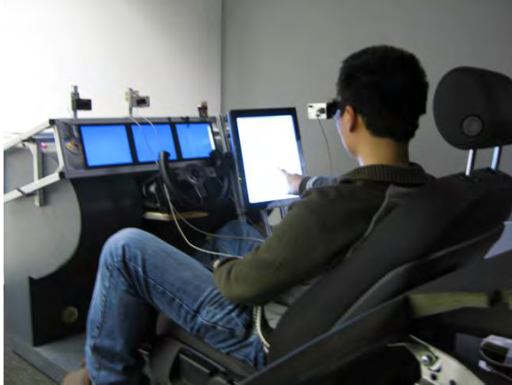
(a) Gesamter Versuchsaufbau mit Sitzkiste. Oberhalb des Armaturenbretts ist das Stereo-Kamera-System zu erkennen.
