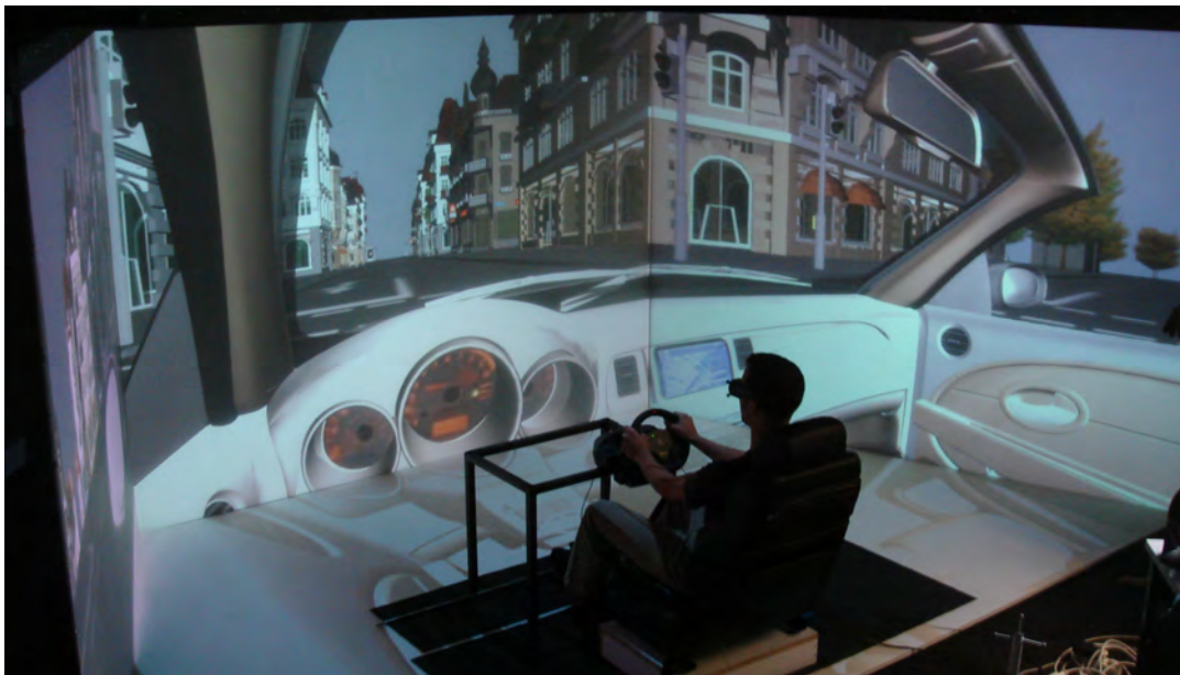
Abbildung 2.9: Der MMK Fahrsimulator. Die Abbildung zeigt die stereoskopische Projektion der Fahrszene sowie der Cockpitenelemente in der Vierseiten-Cave des Lehrstuhls. Die Darstellung ist dabei an die Kopfposition des Probanden angepasst.
