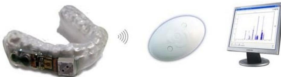
**Abbildung 38: In einer Zahnschiene vergossener pO<sub>2</sub> Sensor und die zugehörige Signalübertragungsstrecke. Das Implantat sendet alle Daten an einen externen Receiver, von dem es auch Befehle entgegennehmen kann. Zur Visualisierung der Daten steht eine Auswertesoftware zur Verfügung (Fotos: Sense Inside GmbH)**
