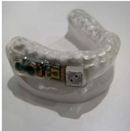
**Abbildung 50: In einer PMMA Zahnschiene vergossene Sensorik (Versuchsmuster)**
