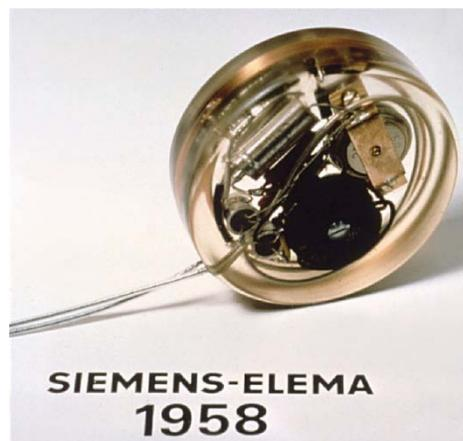
**Abbildung 1: Erster implantierbarer Herzschrittmacher[1]**
