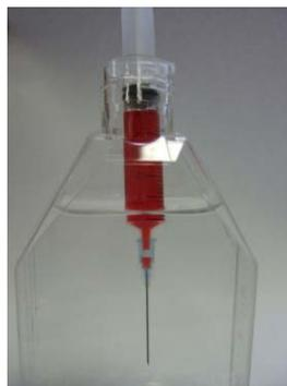
**Abbildung 67: Testen der Austritts von Flüssigkeit aus einer Kanüle mit  $150\mu\text{m}$  Innendurchmesser**
