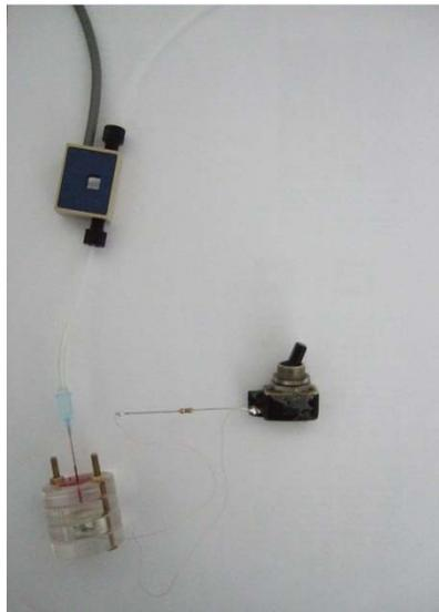
**Abbildung 43: Versuchsaufbau mit Flußratensensor der Gesim GmbH**
