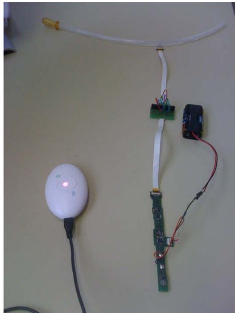
**Abbildung 55: Sensorchip mit angeschlossener Elektronik**
