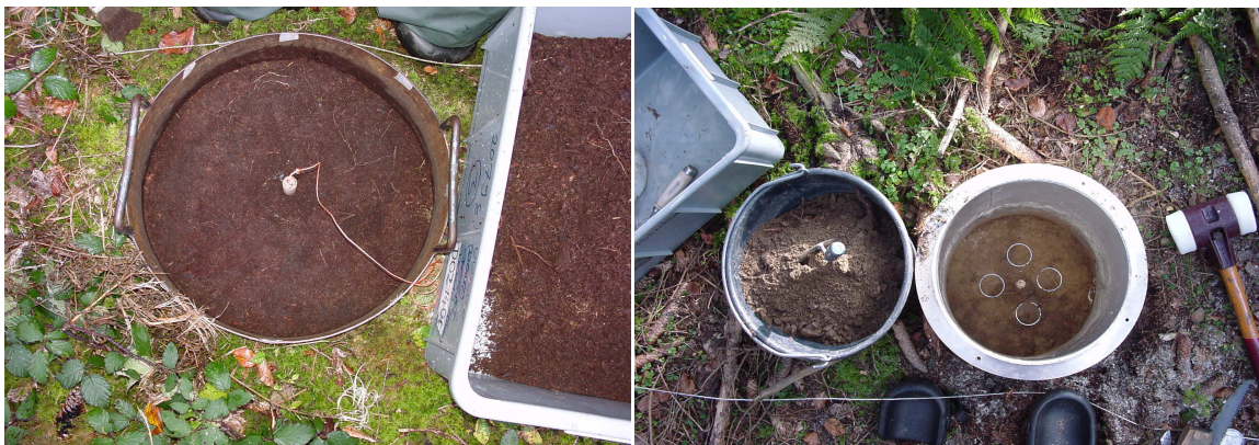
Abb. 5: Humusprobenahme: Stechrahmen mit Saugkerzenplatzhalter im Zentrum (links); Mineralbodenprobenahme: eingetriebener Stechrahmen und eingeschlagene Stechzylinder (rechts).
