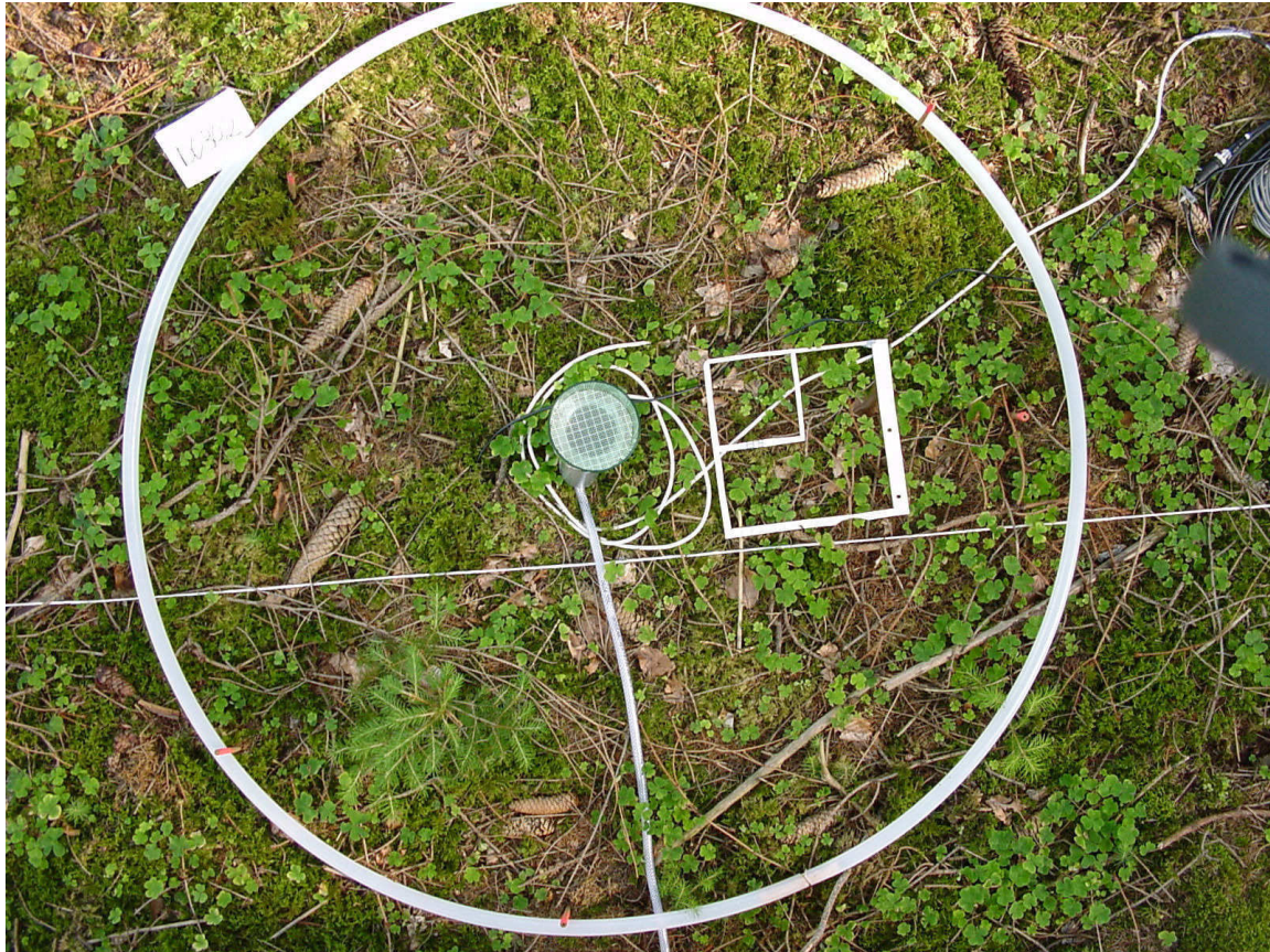
Abb. 4: Niederschlagsfänger direkt über der Saugkerze mit Ring und Rahmen für die Schätzung der Vegetationsdeckungsgrade.
