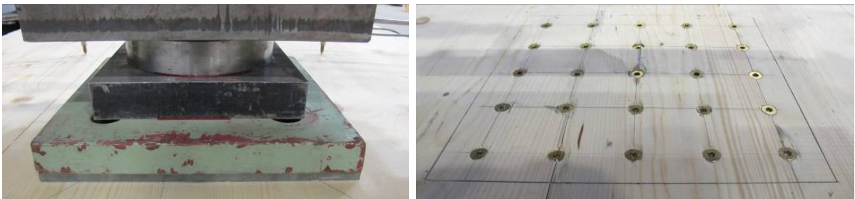
Abbildung 7-10: Versuchsstand, Lasteinleitung und Querdruckverstärkung (Typ 189_P - A-0)
