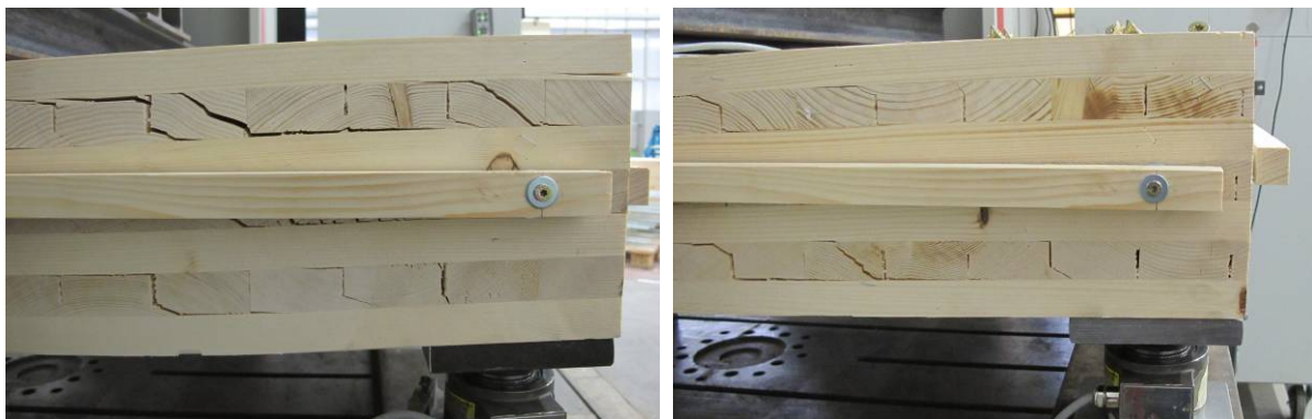
Abbildung 7-29: Rollschubversagen am unverstärkten und schubverstärkten Prüfkörper
