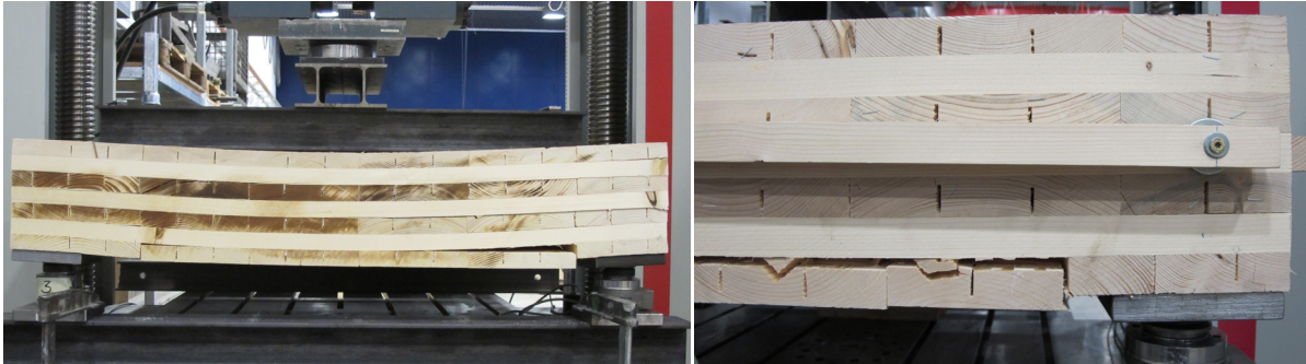
Abbildung 7-30: Versagen der unteren Decklamellen des unverstärkten und schubverstärkten Prüfkörpers
