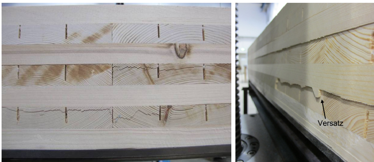
Abbildung 7-14: Schubversagen in Nebentragrichtung (quer zu den Decklagen)
