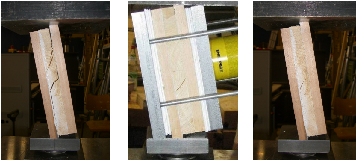
a) Versagen quer zu den Jahringen und anschließendes Aufreißen
