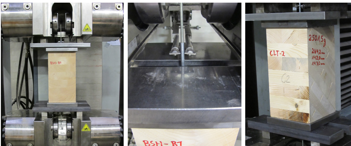
Abbildung 6-25: Versuchsdurchführung zur Ermittlung der Verformungsänderung der Prüfkörper
