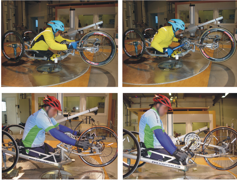
Abbildung 5.11: Unterschiedliche Kurbeltechnik und Oberkörperbewegung beim Kniebiken
