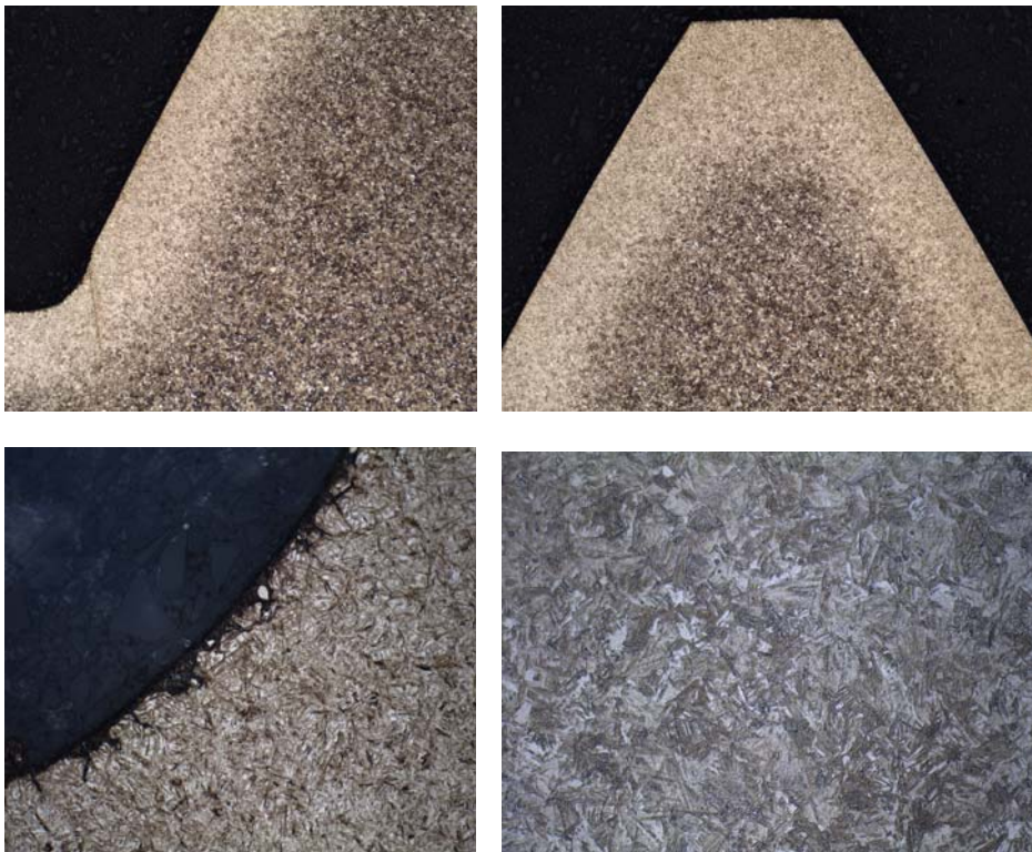
Abbildung 65: Schliff der Verzahnung LFP-ea10-Fu : Übersicht Zahnfuß (oben links); Gesamtübersicht (oben rechts); Randgefüge: feinnadliger Martensit mit wenig Restaustenit (unten links); Kerngefüge (unten rechts)
