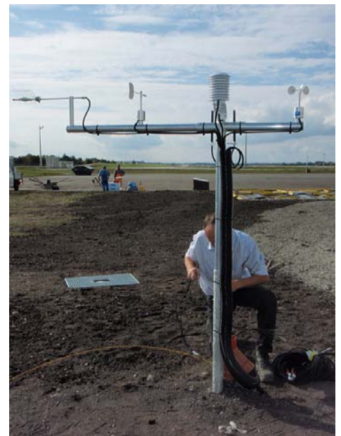
Klimamast mit den Sensoren
