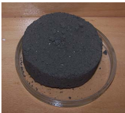
Abb. 6.47: Probe für Saugspannungsmessung
