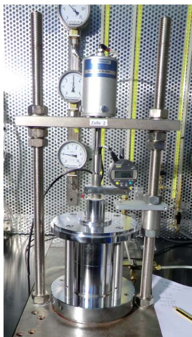
Abb. 6.41: Am Zentrum Geotechnik der TU München entwickelte Oedometerzelle (TUM-Zelle)
