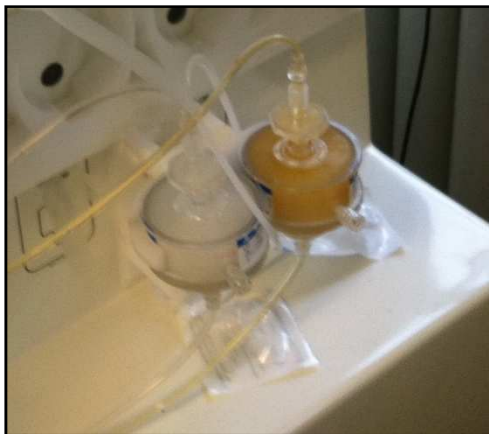
Abbildung 4: Adsorberpaar – ein Adsorber (gelb) wird gerade von Plasma durchspült, während der andere (weiß) regeneriert wird.
