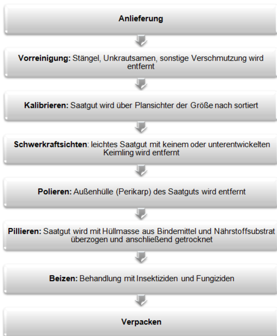
Abbildung 1: Aufbereitungsprozess von Zuckerrübensaatgut
