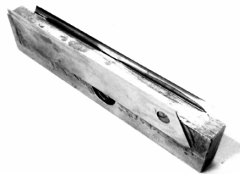
Abbildung 2.12: Quaderförmiger Prüfkörper mit Stanzwerkzeug
