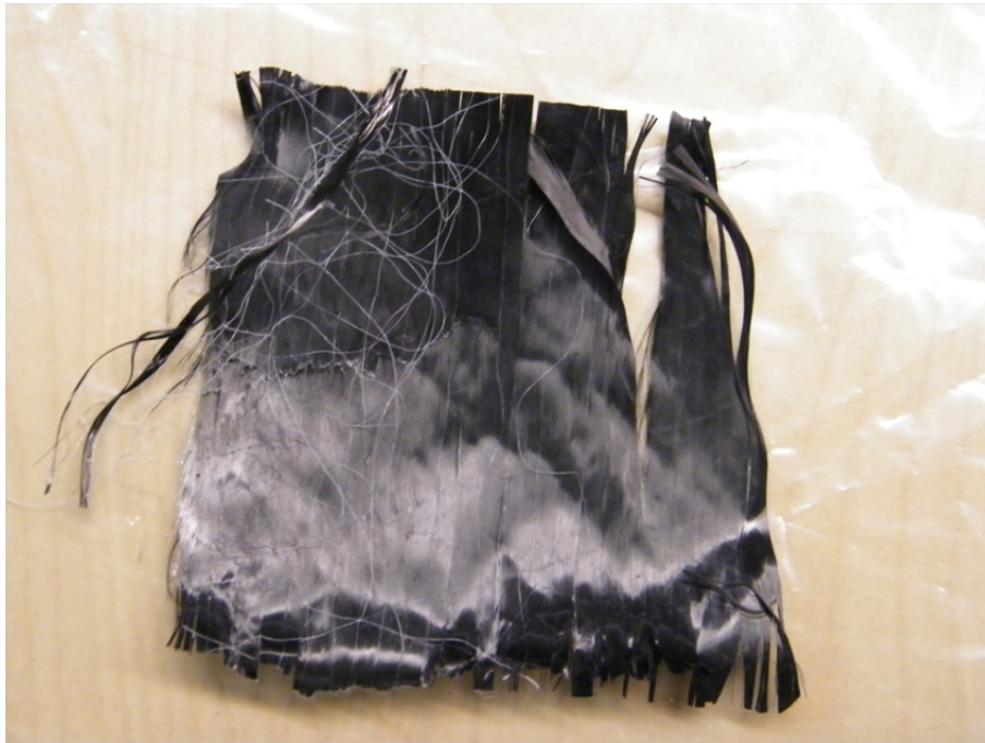
Abbildung 3.3: Verklebte C-Faserfilamente durch den Primer Ciltbond41
