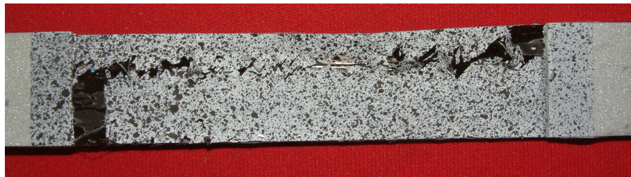
Abbildung 4.59: Typisches Versagen einer UD 0° T700/SilikonRT601 in Faserrichtung
