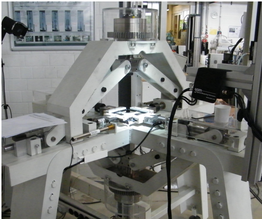
Abbildung 5.9: Biax Prüfmaschine mit eingespannter Kreuzprobe
