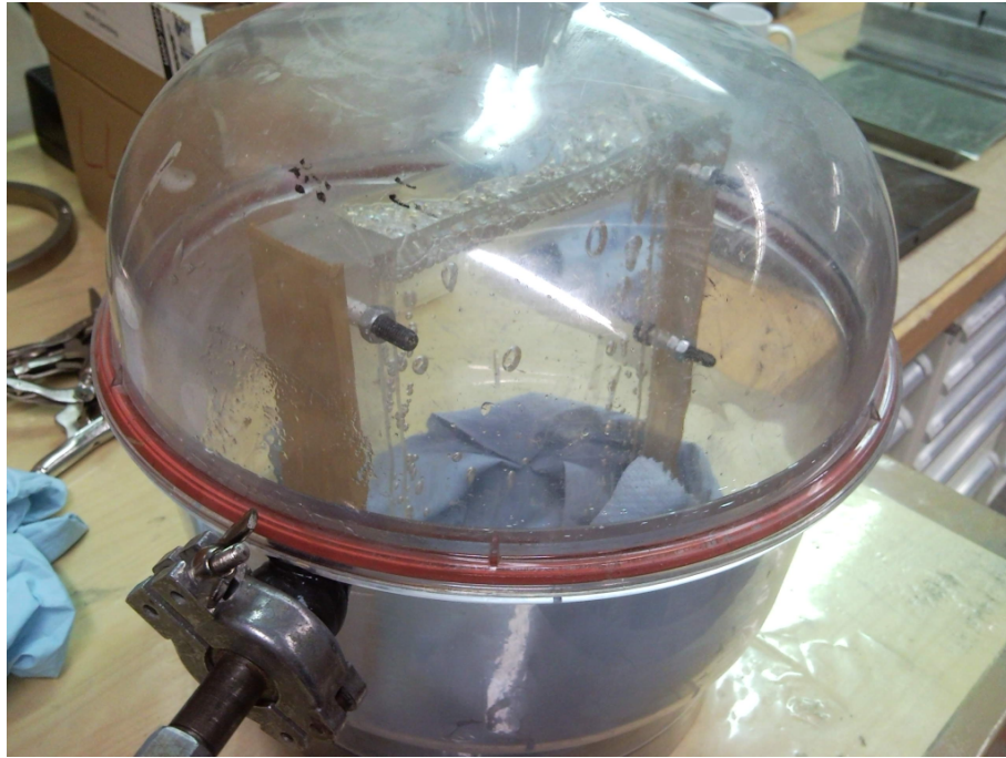
Abbildung 2.10: Elastomerplattenherstellung im Exsikkator
