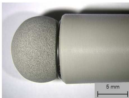
Abbildung 39: Verfärbung an 2-lagig beschichteten Kugeln nach Versuchsende
