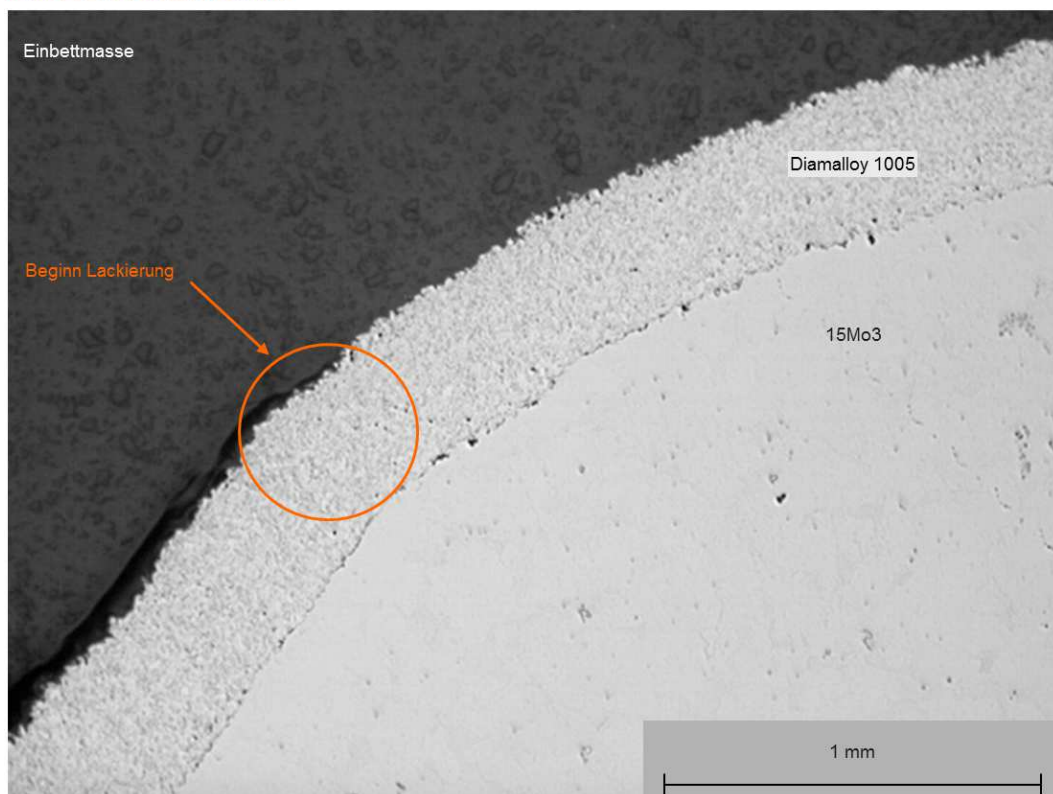
Abbildung 53: Querschliff einer beschichteten teillackierten Kugel nach Versuchsende, Spritzparametersatz 3, Prüfmethode II
