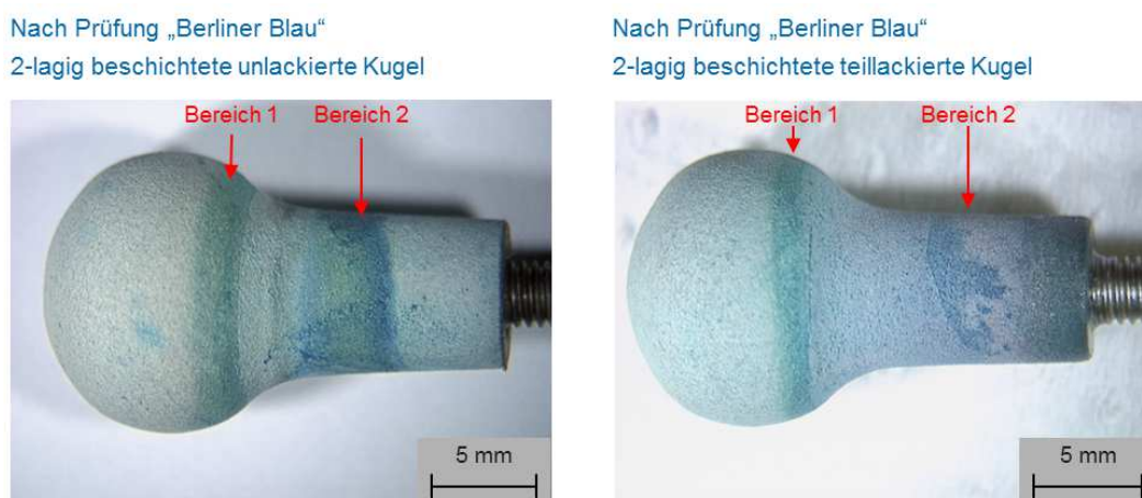
Abbildung 51: 2-lagig beschichtete Kugel nach Prüfung auf „Berliner Blau“; links: Verfärbung an unlackierten Kugeln, rechts: Verfärbung an teillackierten Kugeln
