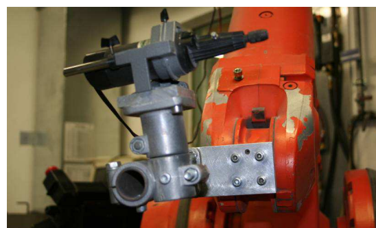
Abbildung 25: Halterung für kugelförmige Probenkörper
