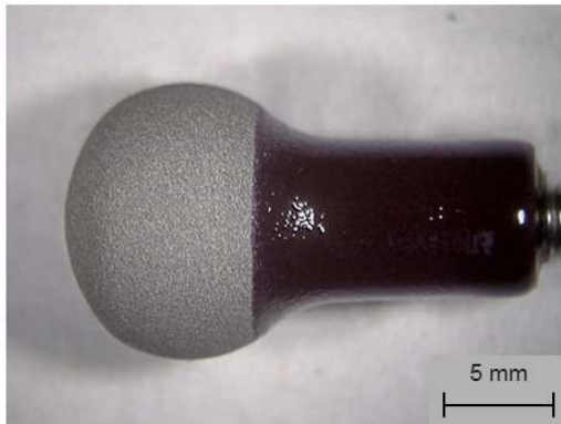
Abbildung 52: 1-lagig beschichtete teillackierte Kugel vor Versuchsbeginn und nach Versuchsende, Spritzparametersatz 3, Prüfmethode II
