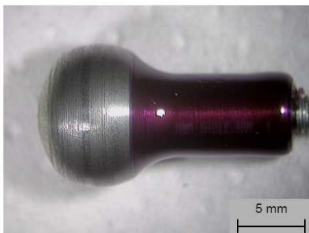
Abbildung 47: Lackierte und unlackierte Kugeln vor Versuchsbeginn und nach Versuchsende; Prüfmethode II
