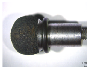
Abbildung 33: Kugel aus 15Mo3 vor und nach einem Nasskorrosionsversuch
