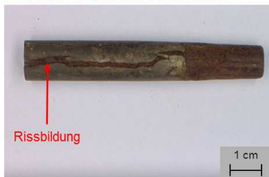
Abbildung 66: Salzseitige Korrosion der Beschichtung, Spritzparametersatz 1, 2, 3, Prüfatmosphäre B
