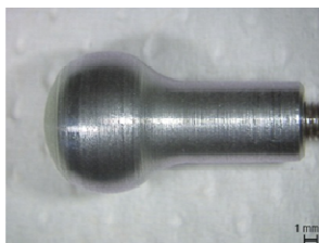
Abbildung 33: Kugel aus 15Mo3 vor und nach einem Nasskorrosionsversuch
