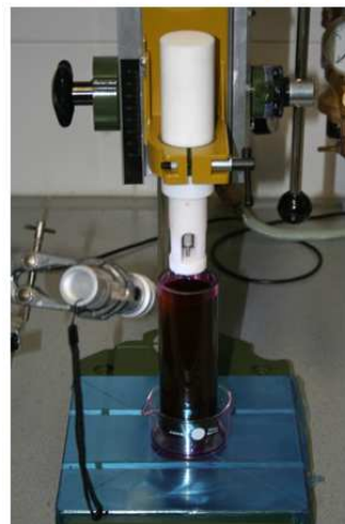
Abbildung 46: Versuchsanordnung zur Lackierung von kugelförmigen Nasskorrosionsproben
