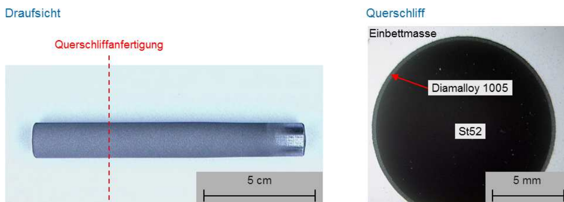
Abbildung 37: Querschliff einer Diamalloy 1005-Funktionsschicht an Hochtemperaturkorrosionsproben
