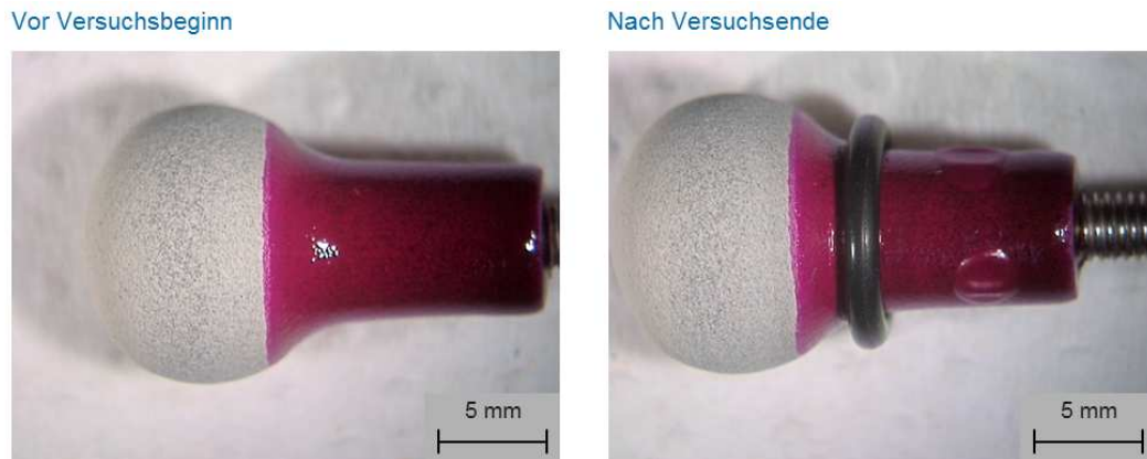
Abbildung 50: Teillackierte 2-lagig beschichtete Kugel von Versuchsbeginn und nach Versuchsende
