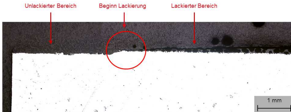
Abbildung 43: Querschliff des teillackierten Rohrabchnittes aus 15Mo3
