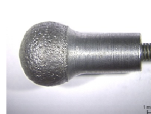
Abbildung 33: Kugel aus 15Mo3 vor und nach einem Nasskorrosionsversuch
