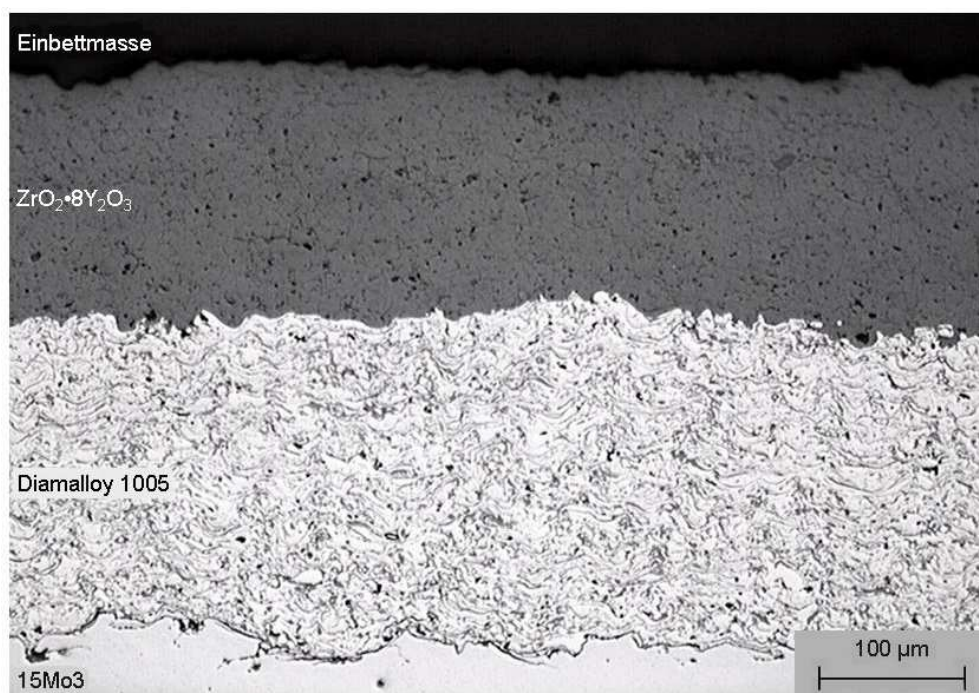
Abbildung 19: Querschliff des Schichtsystems Diamalloy 1005 / Yttriumstabilisiertes Zirkonoxid
