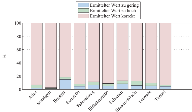
Abbildung 5.22.: Ergebnis der Auswertung zur bestimmten Spurposition von links für die Ergänzung der Interpretationen mit der selbst erstellten Karte, wenn die linke Grenze erkannt wurde - abhängig von Sondersituationen
