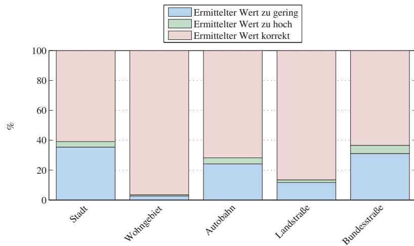
Abbildung 4.42.: Ergebnis der Auswertung zur bestimmten Spuranzahl für die Interpretation der Objektdaten, wenn beide Grenzen erkannt wurden - abhängig von der Straßenklasse
