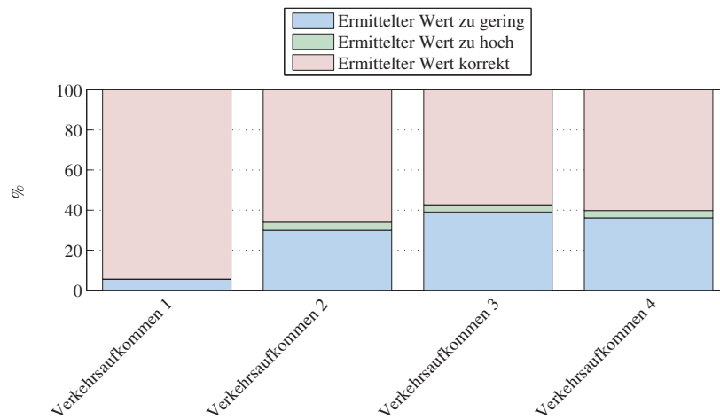
Abbildung 4.48.: Ergebnis der Auswertung zur bestimmten Spuranzahl für die Interpretation der Objektdaten, wenn beide Grenzen erkannt wurden - abhängig vom Verkehrsaufkommen
