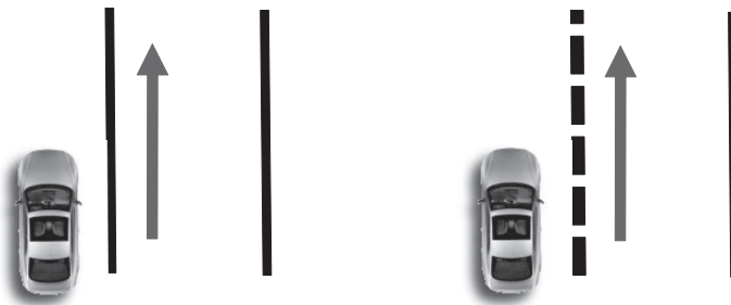
Abbildung 4.19.: Widerlegung der Interpretation der schmalen durchgezogenen und der breiten gestrichelten Linie mit kurzer Lücke von einer Fahrbahngrenze zu einer weiteren Fahrspur in die eigene Fahrtrichtung
