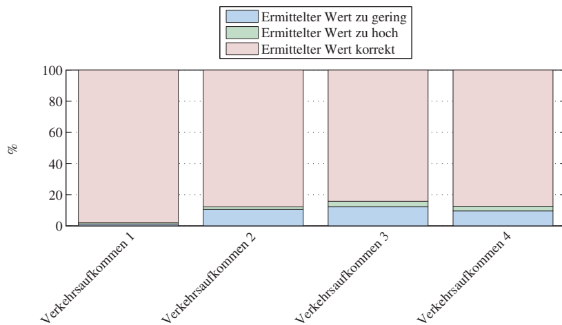
Abbildung C.25.: Ergebnis der Auswertung zur bestimmten Position von rechts für die Fusion der Interpretationen, wenn die rechte Grenze erkannt wurde - abhängig vom Verkehrsaufkommen
