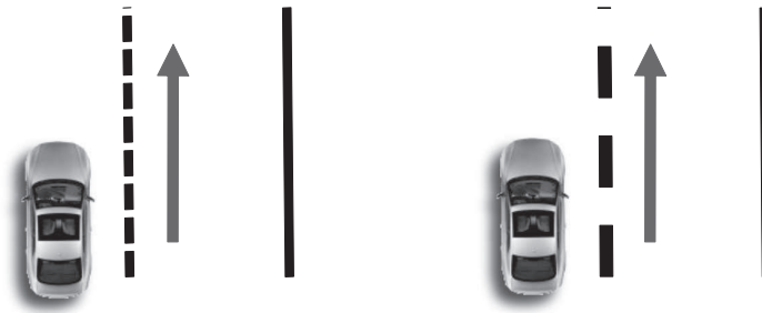
Abbildung 4.20.: Entscheidung für eine weitere Spur in die eigene Fahrtrichtung kann durch weitere erkannte Linien getroffen werden
