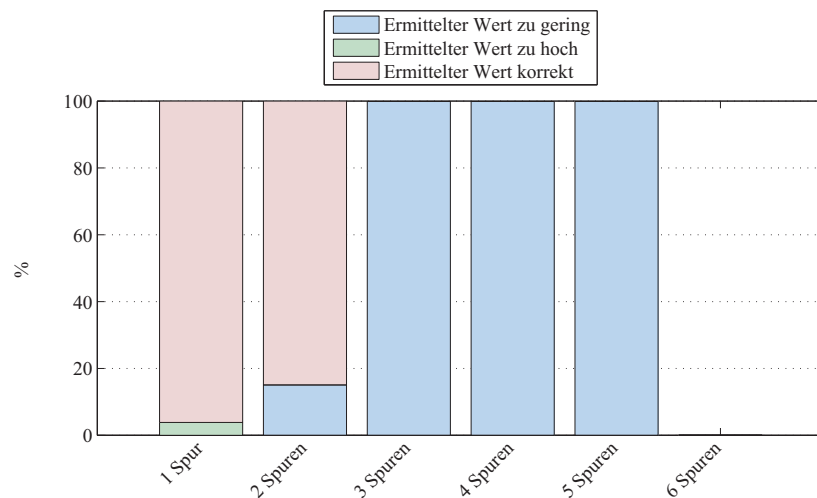
Abbildung 4.27.: Ergebnis der Auswertung zur bestimmten Spuranzahl für die Interpretation der Liniendaten, wenn beide Grenzen erkannt wurden - abhängig von der Spuranzahl
