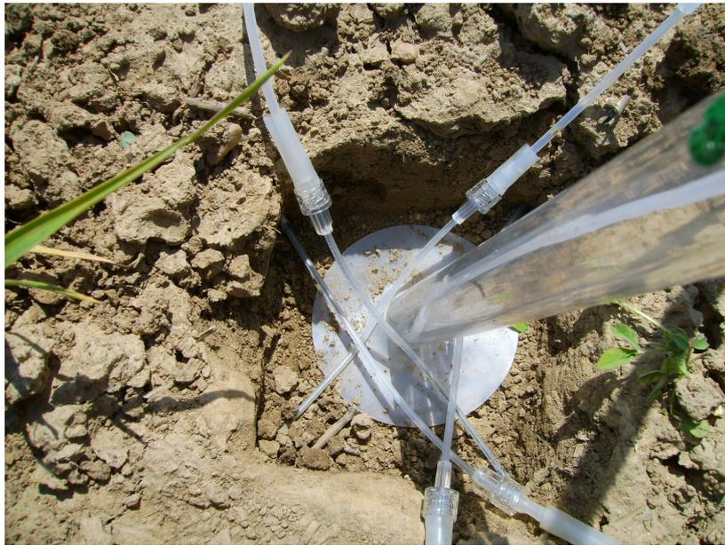
**Abbildung 42: Einbau der Saugkerze (40 cm) und der Mikroaugwurzeln (5 cm)**
