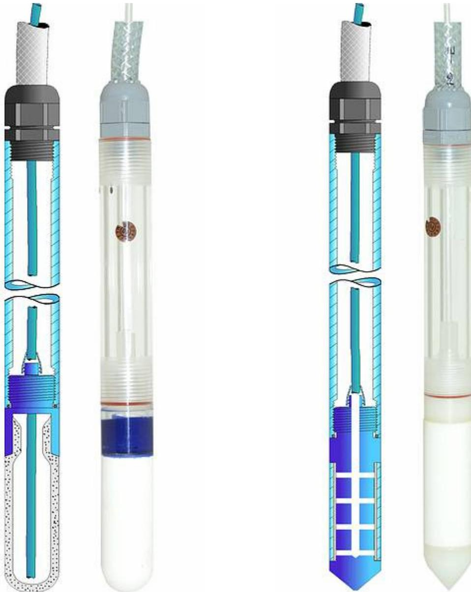
**Abbildung 15: Schematischer Aufbau der verwendeten Saugkerzen**
