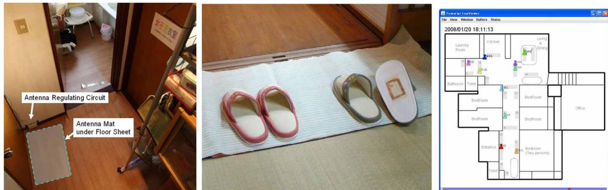
Abbildung 3-8 Komponenten des von Miura et al. (2008) vorgestellten Systems. Links: Fußmatte mit integriertem RFID-Reader. Mitte: Mit Tags präparierte Schuhe. Rechts: Software zur Darstellung von Patientenbewegungen. (Alle Abbildungen entnommen aus: Miura et al. 2008)
