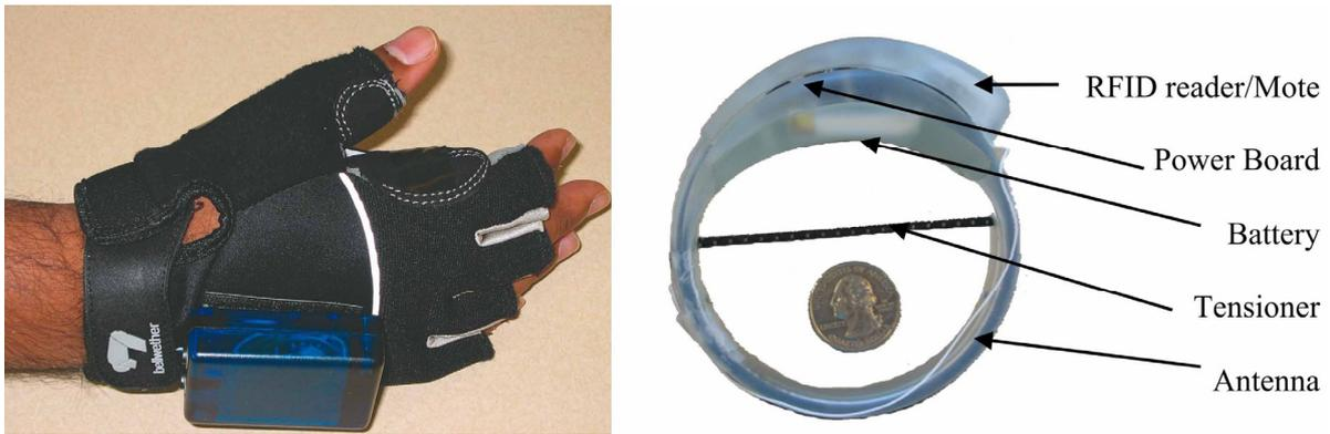
Abbildung 3-9 Tragbare RFID-Reader. Links: Der iGlove. Rechts: Das iBracelet. (Beide Abbildungen entnommen aus: Fishkin, Philipose et Rea 2005)
