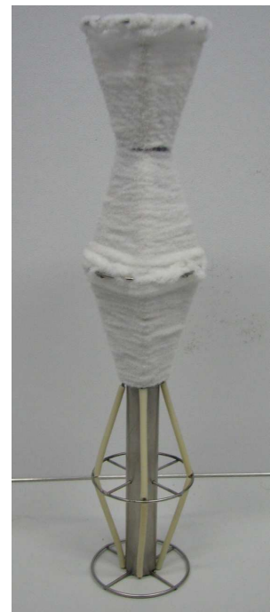
Abb. 28 - Reaktoreinbau zum Aufwickeln von PA6-Effektgarn
