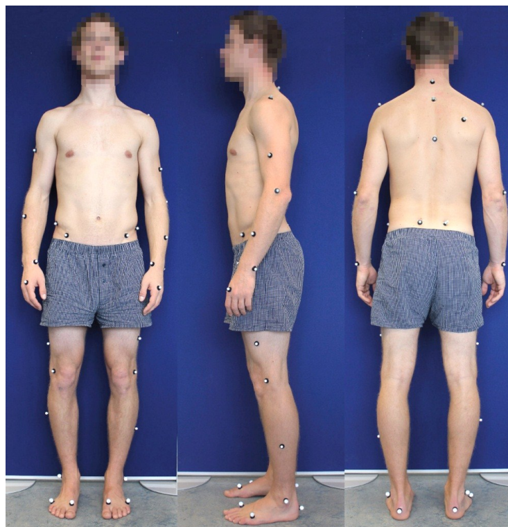
Abbildung 3-1 komplettes Set von Reflexionsmarkern für Ganzkörpermessungen
