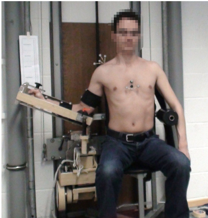
Abbildung 3-8 Gerät zur Messung maximaler Momente des Schultergelenks; Messposition 8 A
