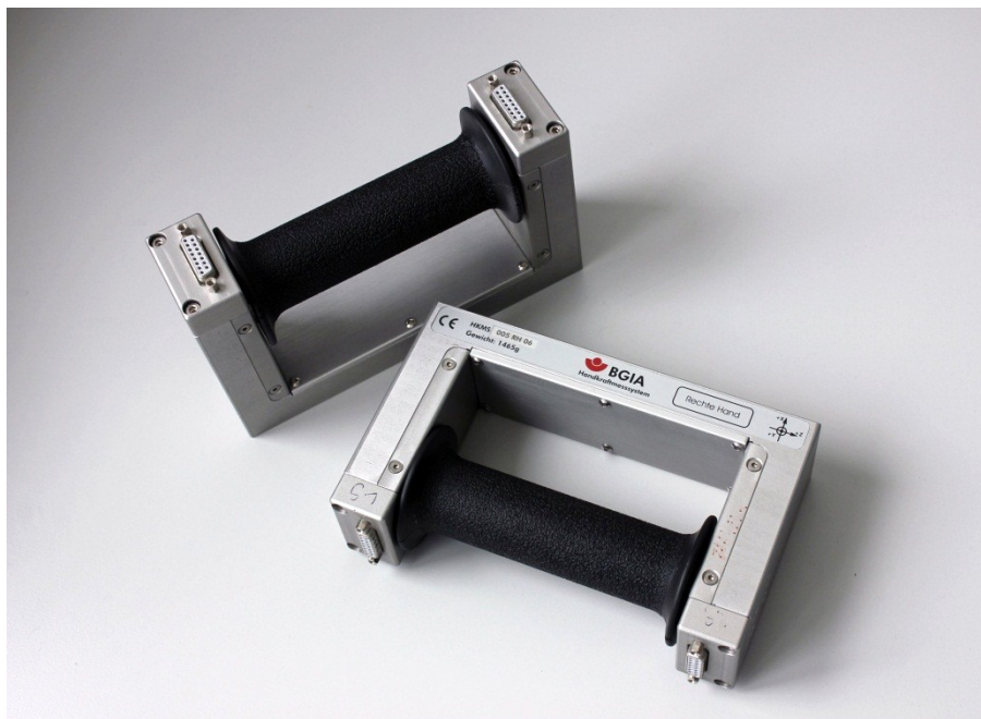
Abbildung 3-11 Griffe des BGIA zur Erfassung von Kräften in drei Raumrichtungen
