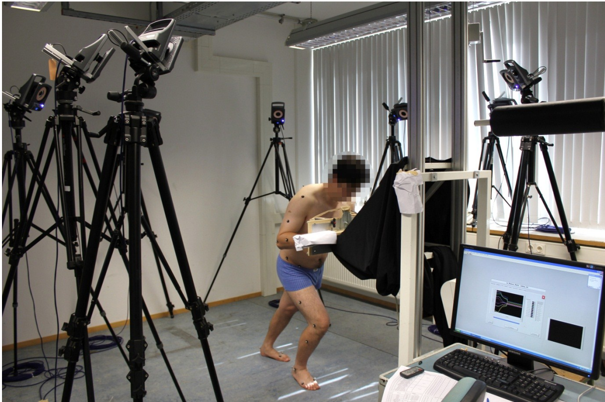
Abbildung 3-12 Aufbau zur Messung maximaler aufgabenbezogener Körperkräfte exemplarisch für Lastfall 17 dargestellt
