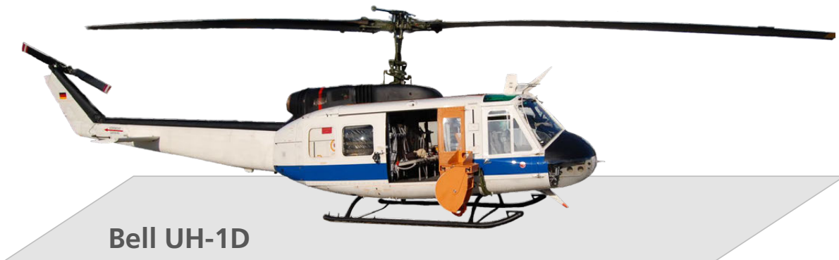
Abbildung 5.1: Hubschrauber mit seitlich angebrachter Sensorplattform (orange).
