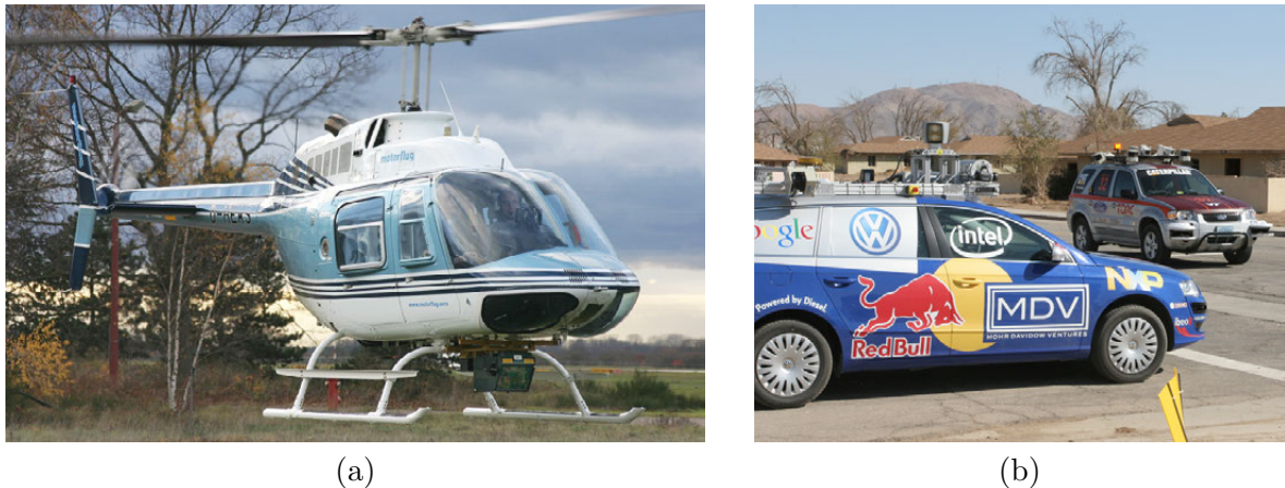
Abbildung 1.2: Beispiele für mobiles Laserscanning mit sofortiger Datenauswertung: (a) Bell 206 mit HELLAS Hinderniswarnsystem. Mit freundlicher Genehmigung von S. Albrecht (Bildurheber). (b) Autonom gesteuerte Fahrzeuge bei der DARPA Urban Challenge 2007. Bild: Regierung der Vereinigten Staaten (gemeinfrei).
