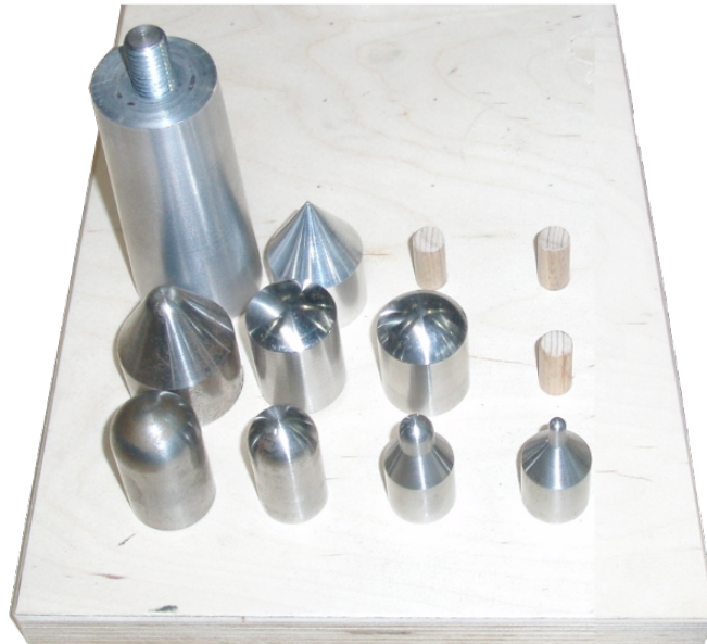
Abbildung 6.2: Sammlung unterschiedlicher Impactorgeometrien zur Verwendung in einer Fallbolzenanlage
