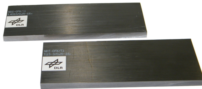
Abbildung 6.20: Faserverbund-Metallhybridplatten mit eingebrachten Fehlstellen: Stahl-CFK-Hybrid mit 16 Lagen 1.4310 Stahl (0,25 mm Stärke) oben und Titan-CFK-Hybrid mit 16 Lagen Ti15-3 Titan (0,25 mm Stärke) unten [78]
