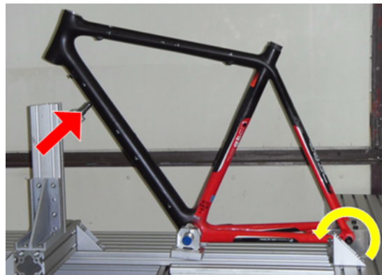
Abbildung 9.3: Versuchsaufbau für Impacteinbringung [73]
