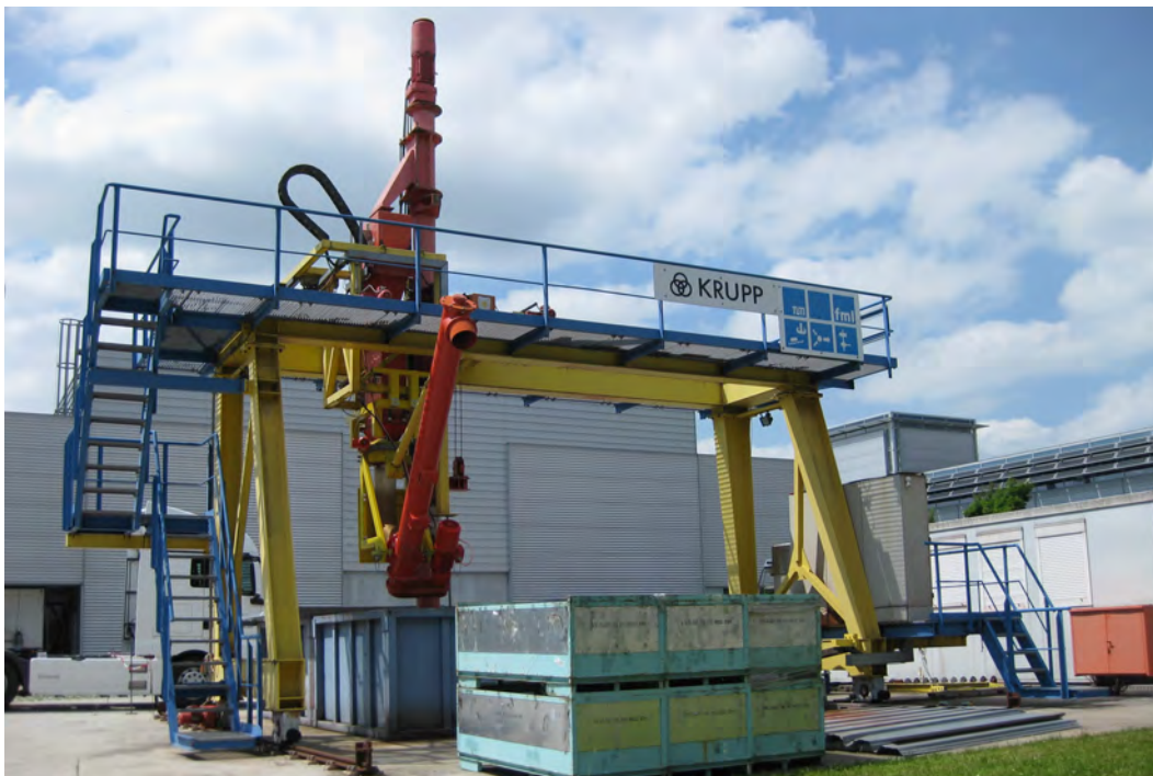
Abbildung 5-1: Versuchsanlage zur Untersuchung stark geneigter Schneckenförderer
