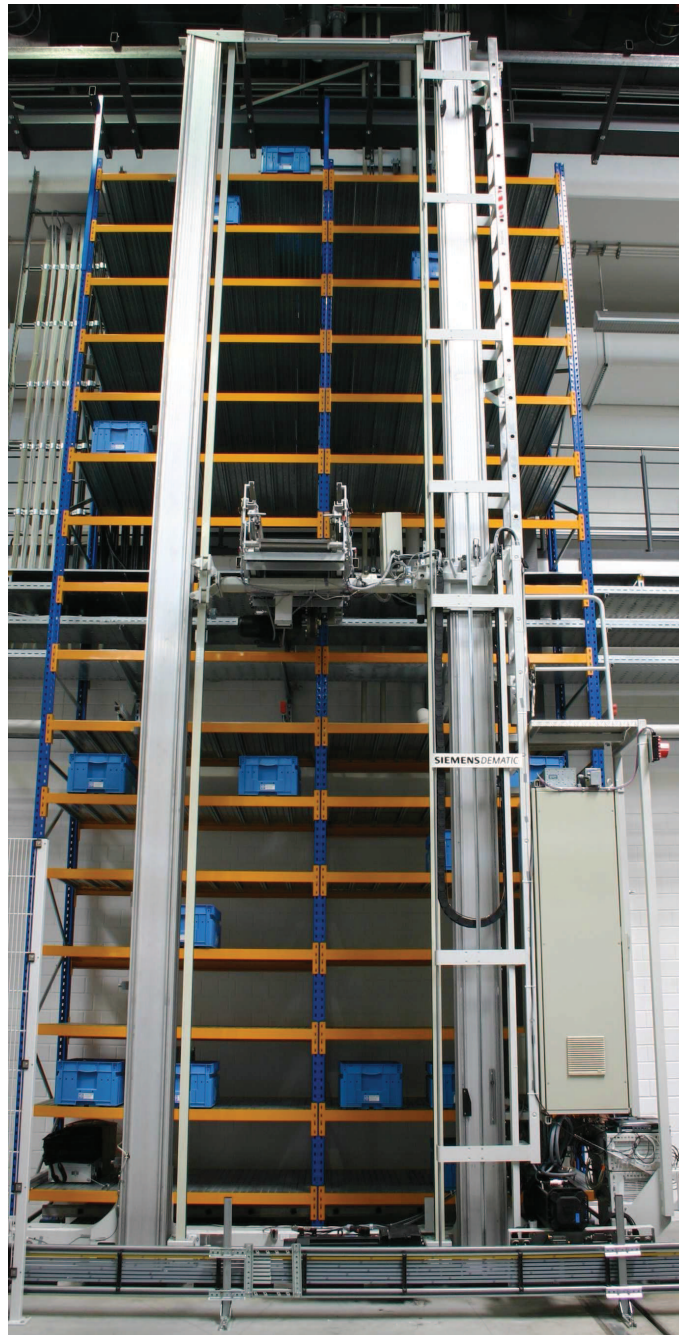
Bild 1.1: Beispiel Regalbediengerät: Oftmals wird der Durchsatz durch tolerierbare Nachschwingungsamplituden begrenzt.
