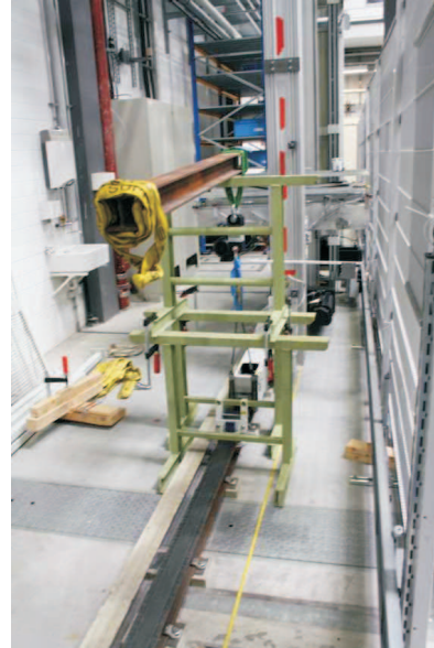
Bild 7.2: Messvorrichtung zur Ermittlung der Hebekraft F_2
