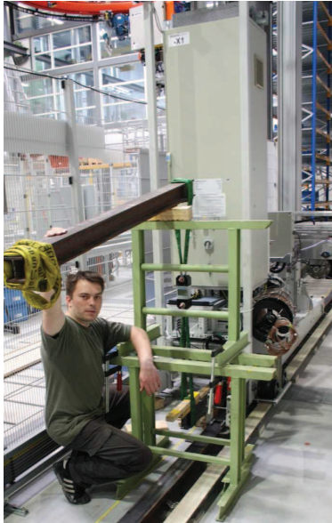
Bild 7.1: Messvorrichtung zur Ermittlung der Hebekraft F_1
