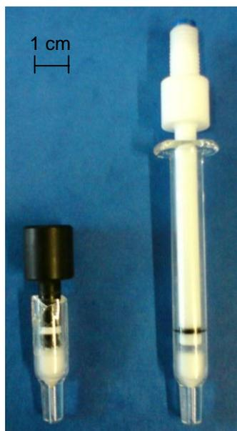
**Abbildung 3.12:** POM-Fitting (links), PTFE-Fitting (rechts).
