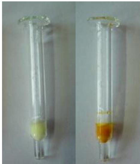
**Abbildung 3.7:** TNBS-Test: Negativkontrolle (links) und Säule mit DAPEG-Belegung (rechts) zum Nachweis der DAPEG-Belegung.
