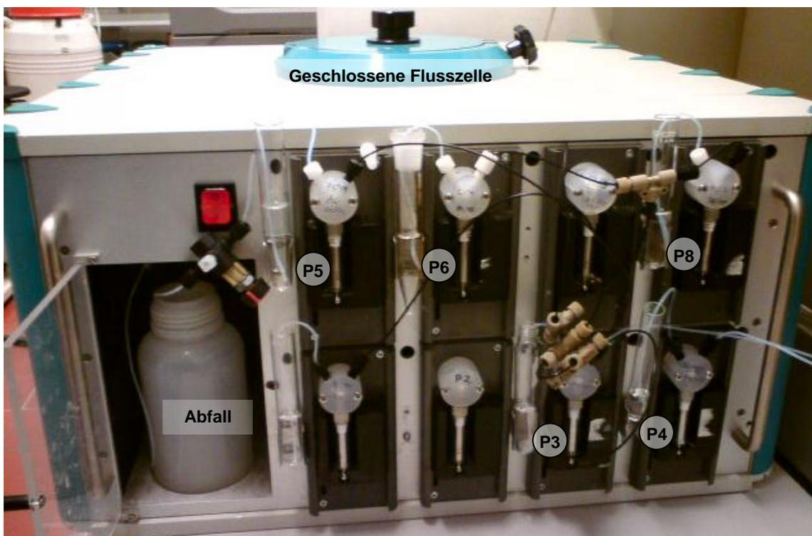
**Abbildung 5.4:** Mikroarray-Auslesegerät Immunomat: (P3) Bakterienprobe, (P4) Laufpuffer, (P5) HRP-markierter Detektionsantikörper, (P6) Luminol, (P8) Wasserstoffperoxid.
