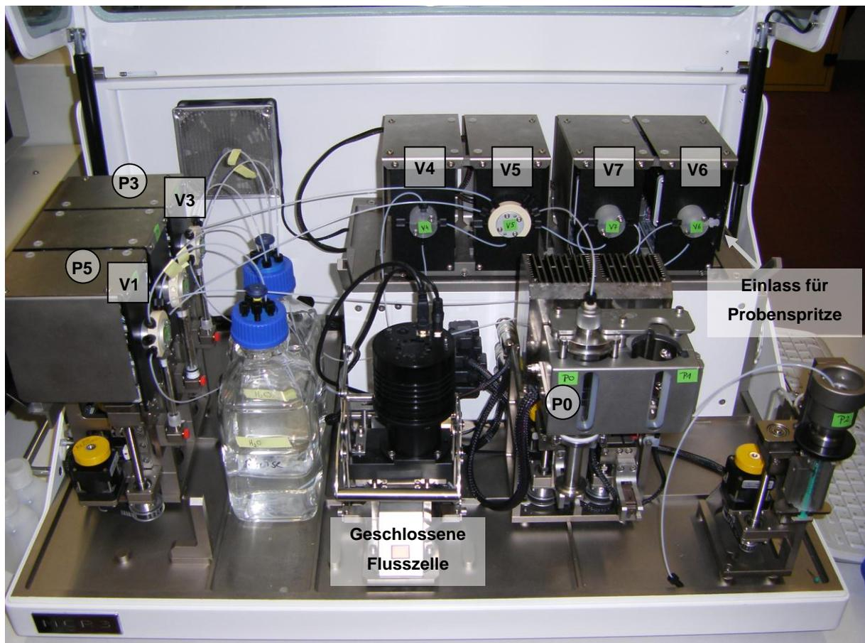
**Abbildung 5.7:** Aufbau des MCR3 SLT: Einlass für Probenspritze, (P0) Detektionsantikörper-Spritze, (P3) Substratspritze, (P5) Spülspritze, (V1, V3, V5) Sechsfach-Ventile, (V6, V7) T-Ventile, (V4) Ventil zu den Flusszellen, geschlossene Flusszelle.
