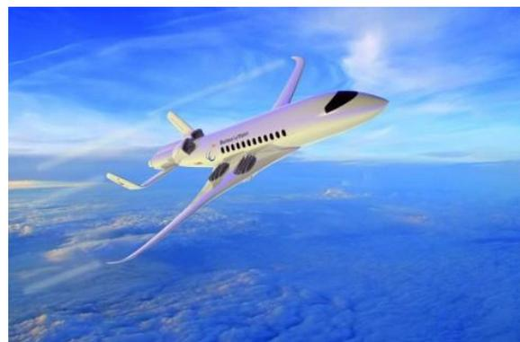
Abb. 6-6: Computergrafik des Hyliner Regional Jet - kurzstart- und -landefähiges ESTOL Flugzeugkonzept des Bauhaus Luftfahrt e.V.
