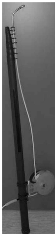
Abb. 9: Teleskopmast zur punktgenauen Positionierung des Gaseinlasses der mobilen VOC-Sammeleinheit (Foto: Steinbrecher)
