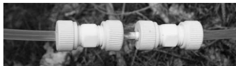
Abb. 11: Verbindungsstücke (Bohlender GmbH, Grünsfeld, Deutschland) zur Integration der Adsorptionsröhrchen
