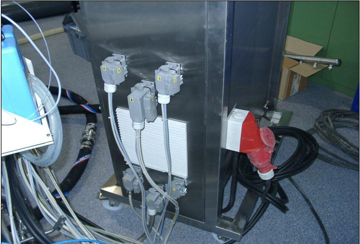
Abbildung Anhang 3: Stromversorgung (rot) und Kabelverbindung Modul - Schaltschrank
