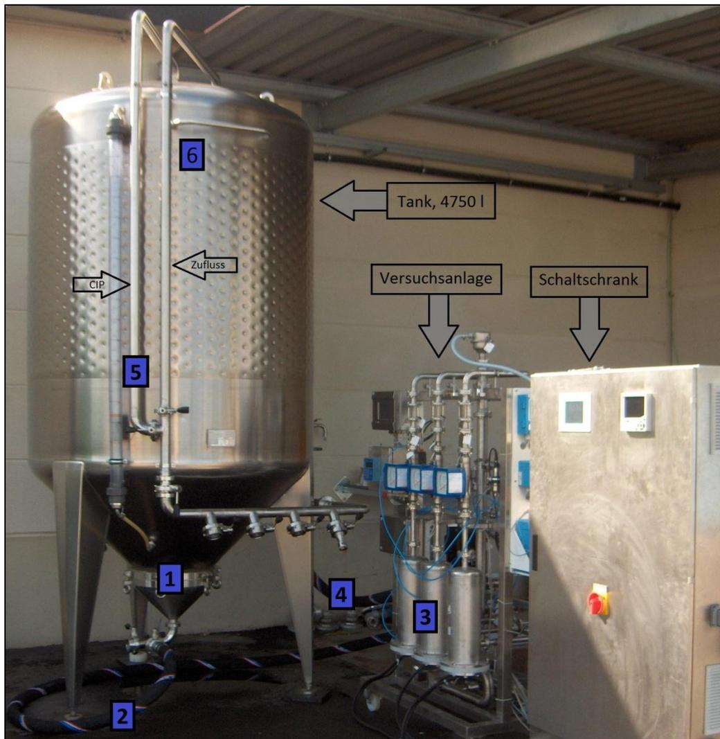
Abbildung 35: Versuchsaufbau der Pilotanlage mit Tank
