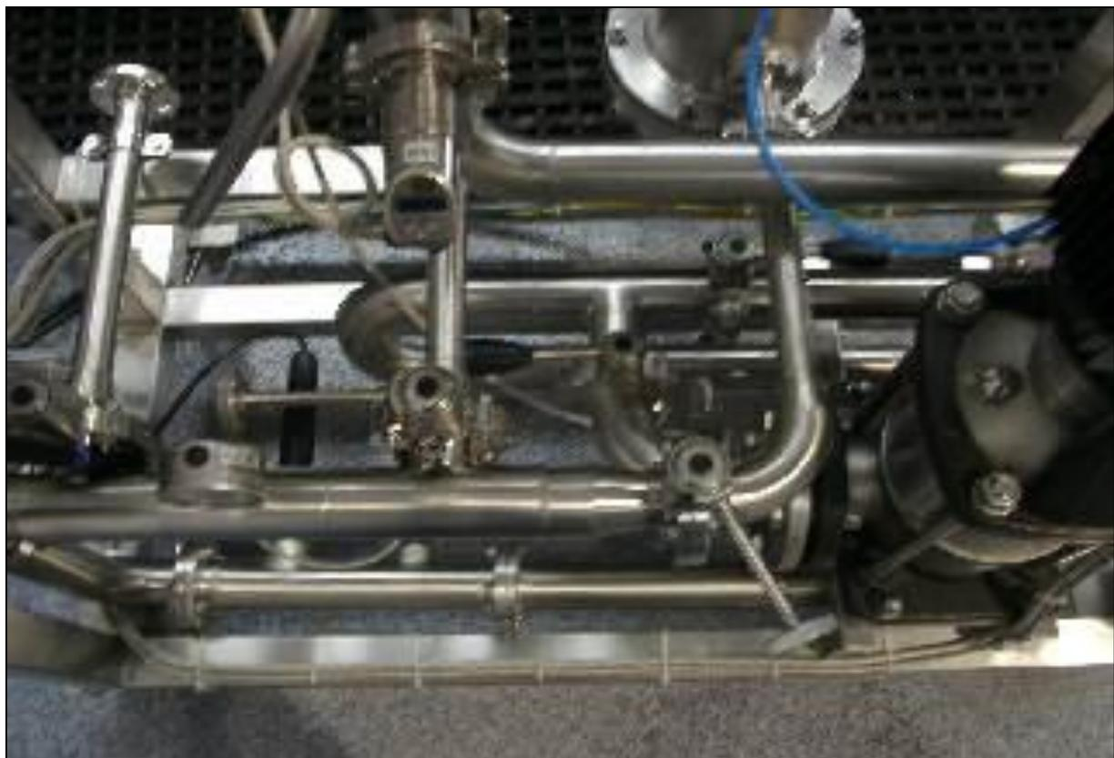
Abbildung Anhang 18: Ventile mit Rändelschrauben zur Feinregulierung des Volumenstroms
