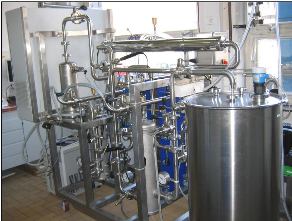
Abbildung 32: Versuchsanlage zur Evaluierung von Entkalkungsroutinen
