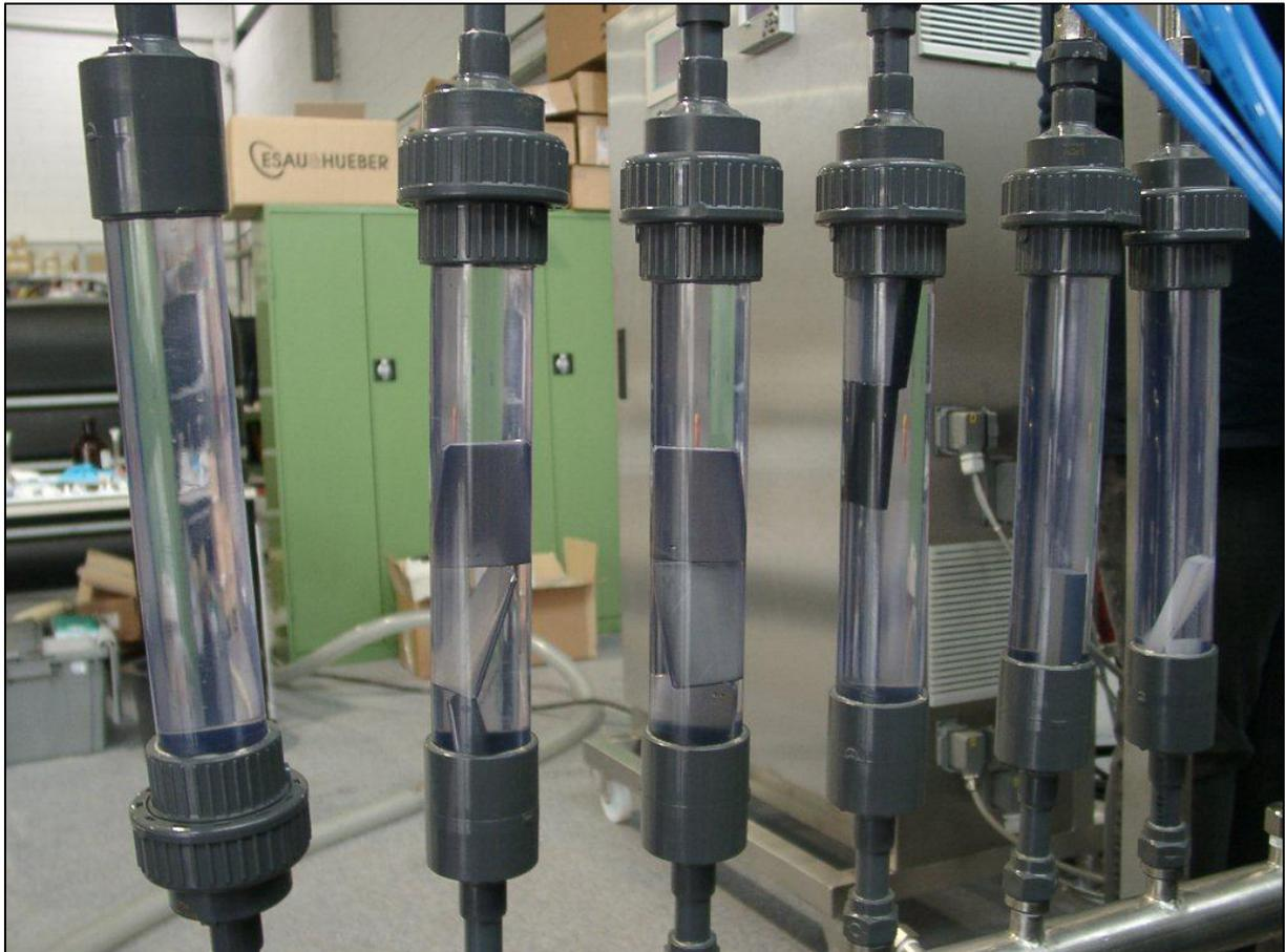
Abbildung 128: Versuchsaufbau Materialtest (zu sehen sind die einzelnen Materialkapseln, befüllt mit Materialstreifen)
