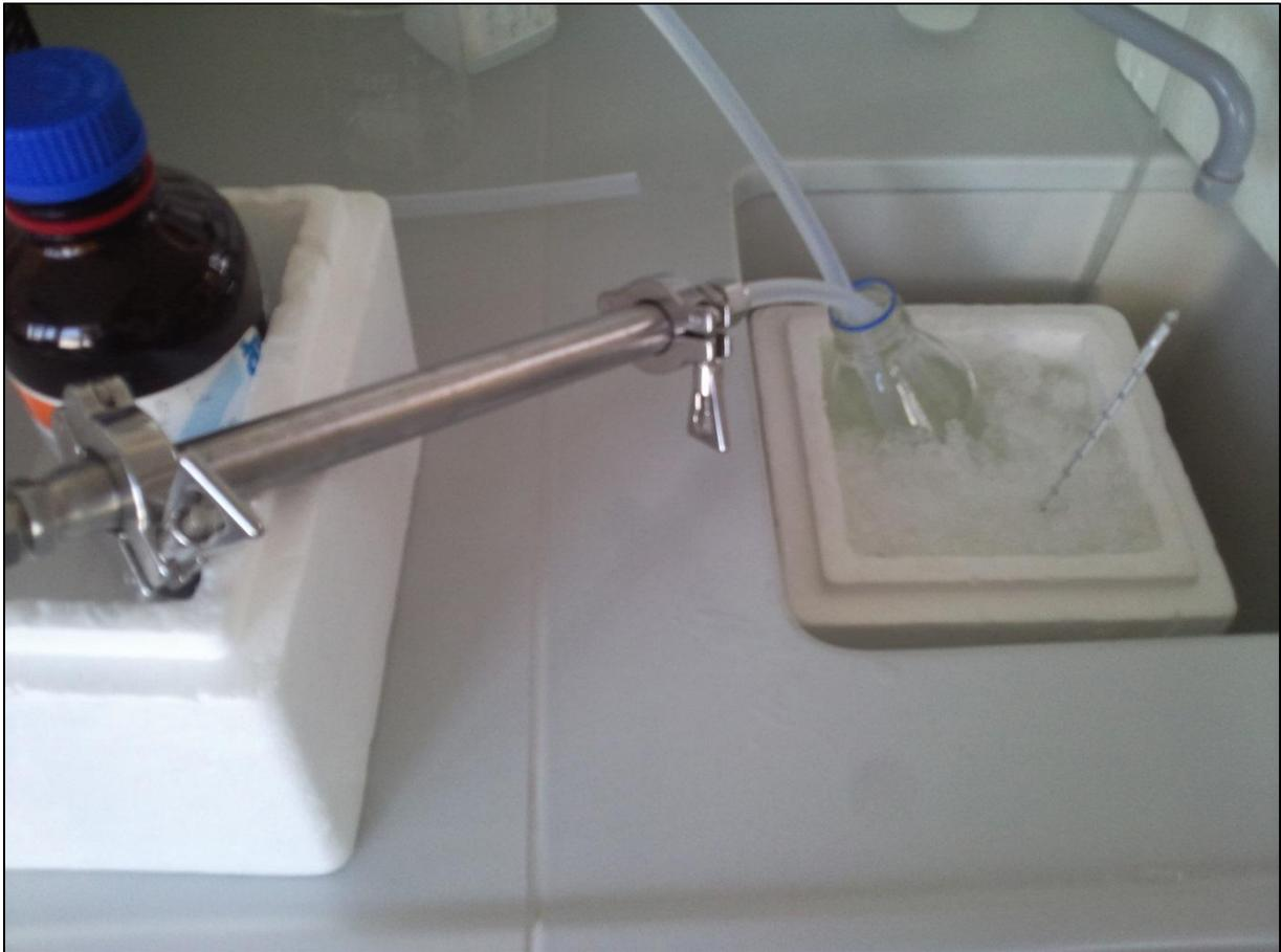
Abbildung 112: Versuchsaufbau "angetrocknete Keime", Metallplättchenaufnahme im Rücklauf der Laboranlage
