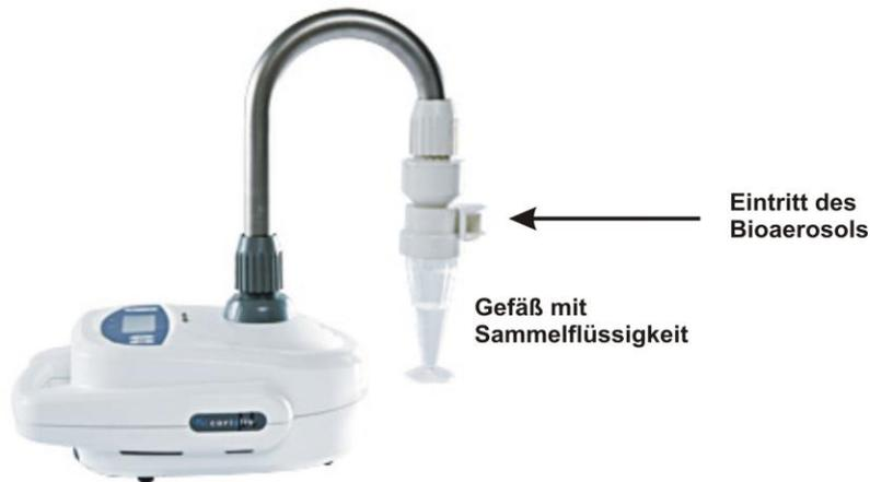
**Abbildung 6.7:** Zyklonsammler Coriolis  $\mu$  [273].
