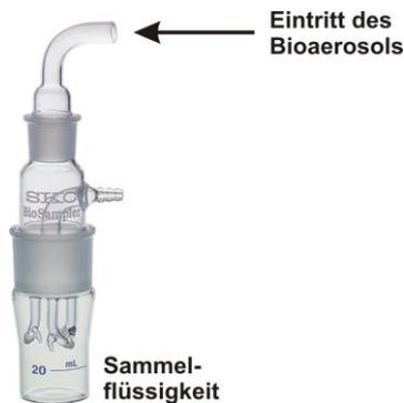
**Abbildung 6.8:** Bioaerosol-Sammelgerät AGI-30 [274].
