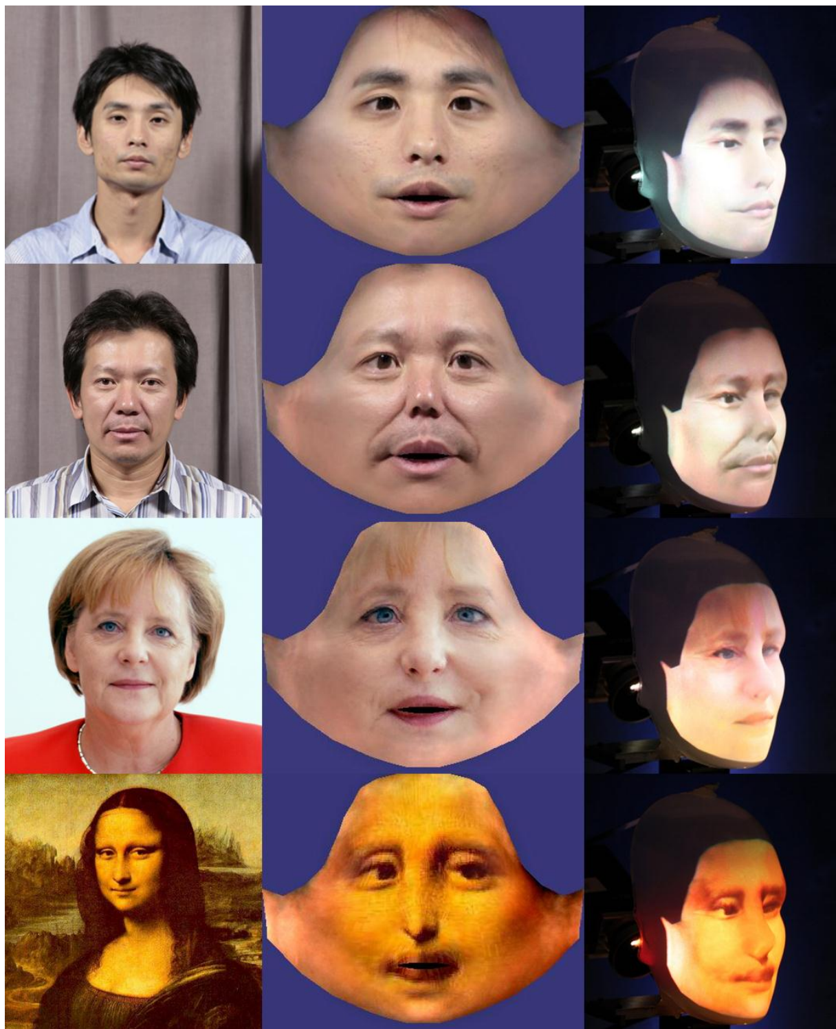
図 11. 提案手法により合成されたテクスチャと Mask-bot への投影結果 左: 原画像 中央: 合成されたテクスチャ 右: Mask-bot への投影結果
