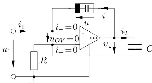
Abbildung 11.9: OPV-Schaltung für Memristor
