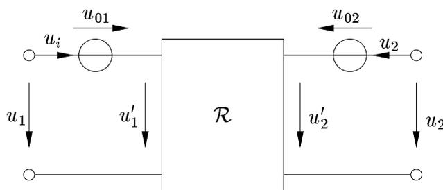
Abbildung L13.9: zu L13.4, 2. Schritt, Ersatzschaltbild: Widerstandsmatrix
