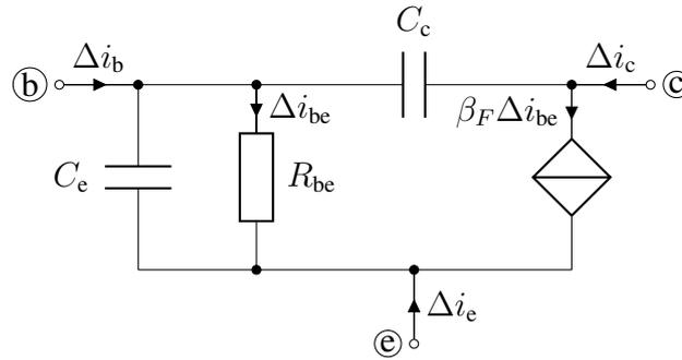
Abbildung 14.7: Dynamisches Kleinsignalersatzschaltbild des Transistors für den Vorwärtsbetrieb
