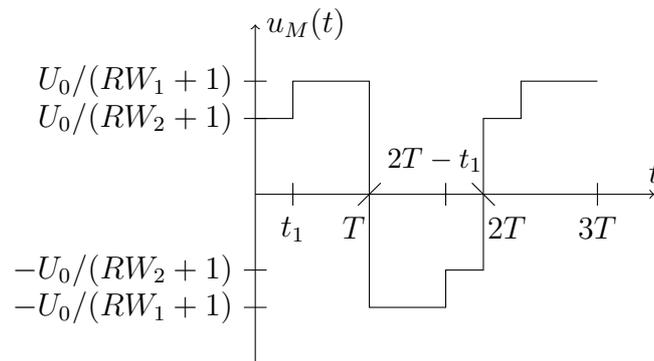
Abbildung L12.58: zu L12.18: Spannungsverlauf am Memristor über die Zeit
