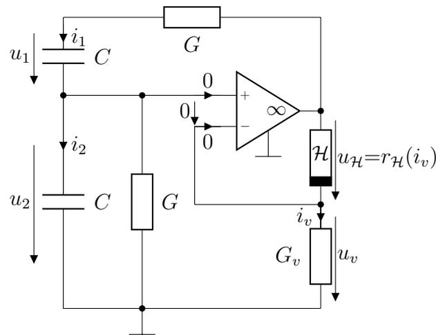
Abbildung 14.4: Wien-Oszillator
