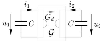
Abbildung 14.2: Schwingkreis mit Gyrator
