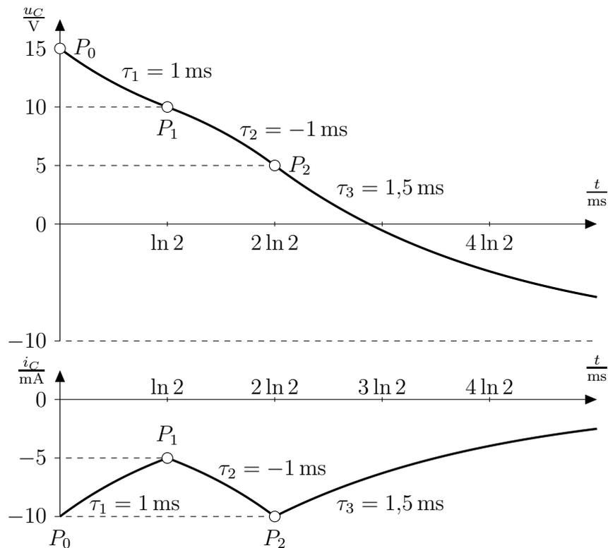
Abbildung L12.32: Zeitverlauf von  $u_C$  und  $i_C$
