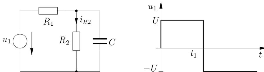
Abbildung 12.3: Stückweise konstante Erregung
