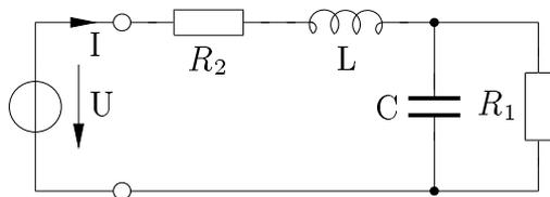
Abbildung 16.1: Schaltung zur komplexen Wechselstromrechnung (A)
