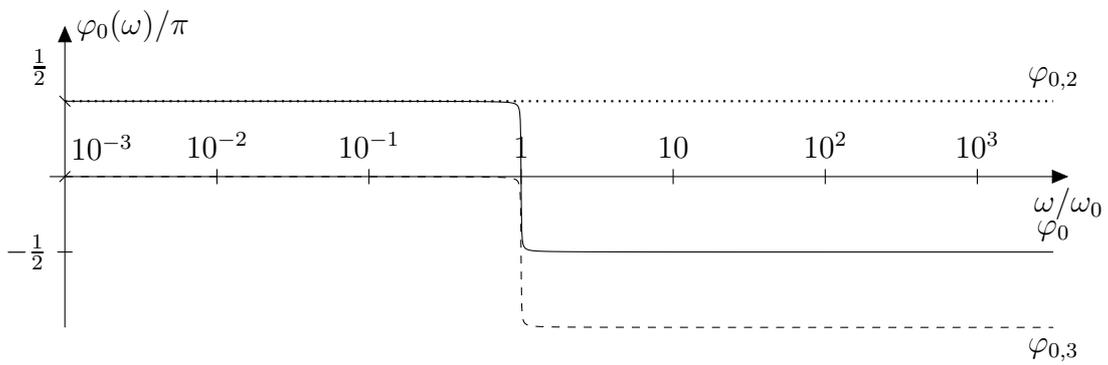
Abbildung L16.27: zu L16.11 e: Phasenverlauf von  $H_0(j\omega)$
