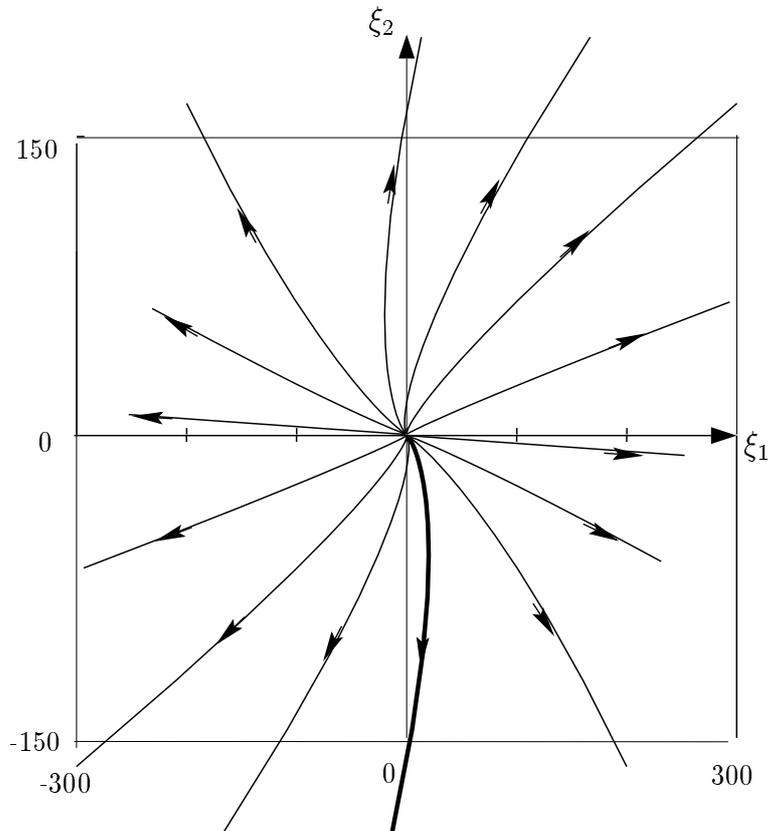
Abbildung L13.43: Phasenportrait des instabilen Knotenpunktes für zwei gleiche Eigenwerte
