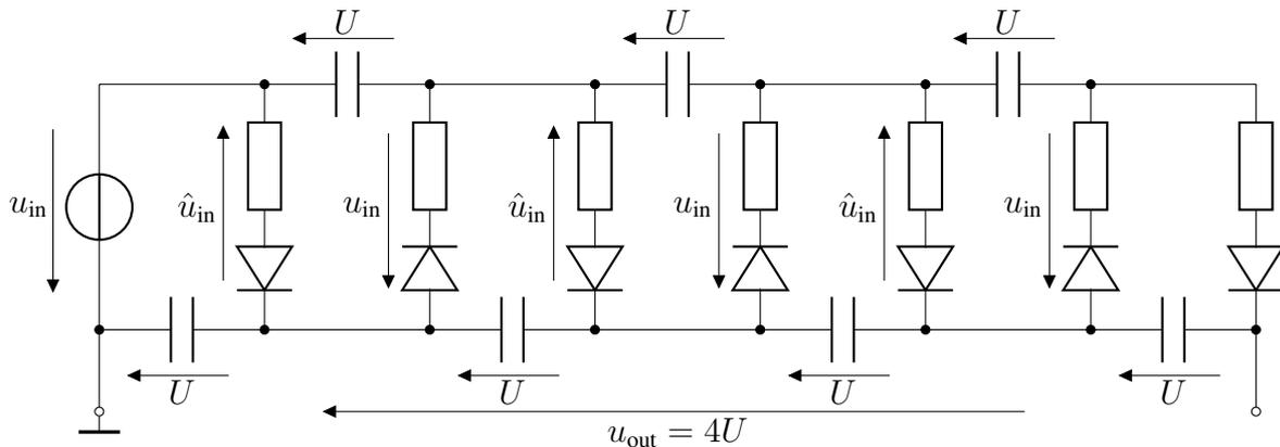
Abbildung L12.13: Spannungsvervielfacher für  $t \rightarrow \infty$  s
