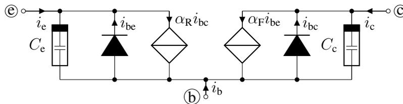
Abbildung 14.6: Dynamisches Großsignalmodell des npn-Transistors
