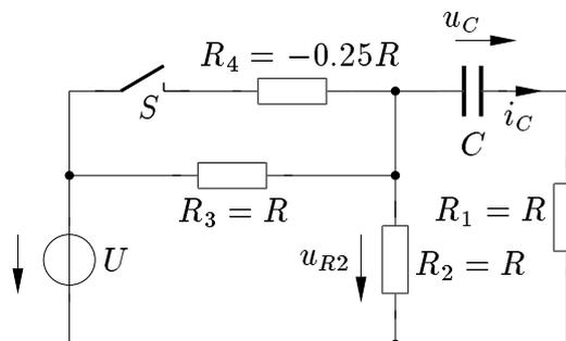
Abbildung 12.9: RC-Schaltung mit Schalter
