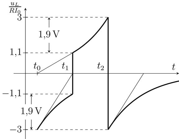
Abbildung L12.26: zu L12.10 b: Zeitverlauf  $u_L(t)$
