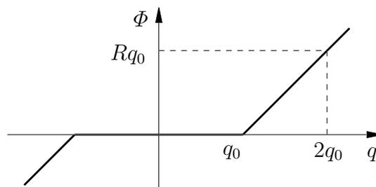
Abbildung 11.7: Memristorkennlinie
