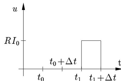
Abbildung L11.15: zu L11.7 d: Zeitverlauf  $u(t)$
