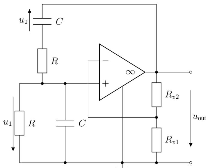
Abbildung 13.9: Wien-Robinson-Oszillator
