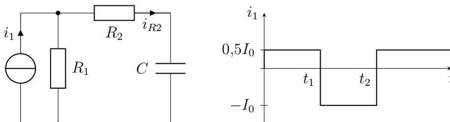
Abbildung 12.4: Stückweise konstante Erregung
