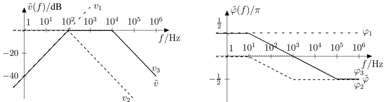
Abbildung L16.25: zu L16.11 e: Betragsverlauf und Phasenverlauf von  $\frac{U_{\text{out}}}{U_3}$
