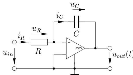
Abbildung L12.18: zu L12.8 b: Integrierer
