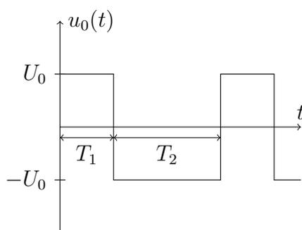
Abbildung 12.20: Verlauf der Erregung
