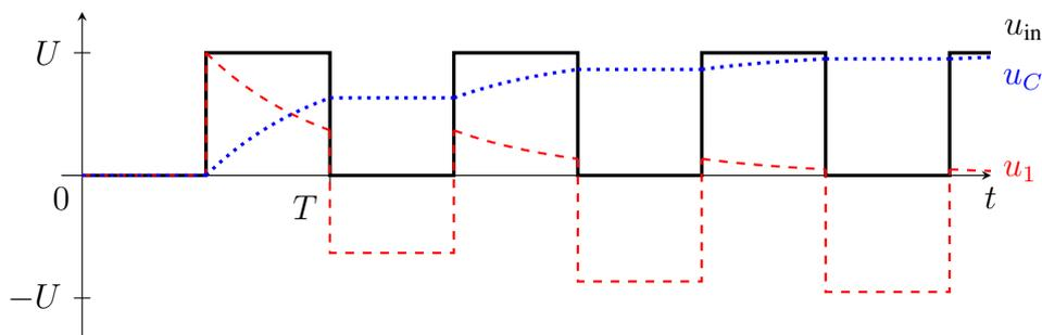
Abbildung L12.12: Zeitverlauf an der ersten Stufe des Spannungsvervielfachers
