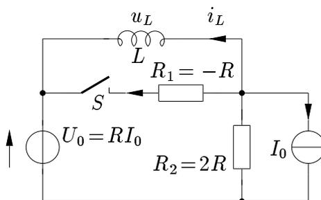
Abbildung 12.10: RL-Schaltung mit Schalter
