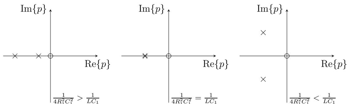
Abbildung L16.24: zu L16.11 d: Pol-Nullstellen-Diagramme
