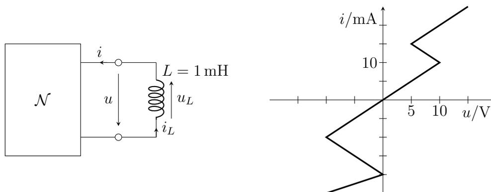
Abbildung 12.12: zu 12.12: Zweipol  $\mathcal{N}$  mit Induktivität
