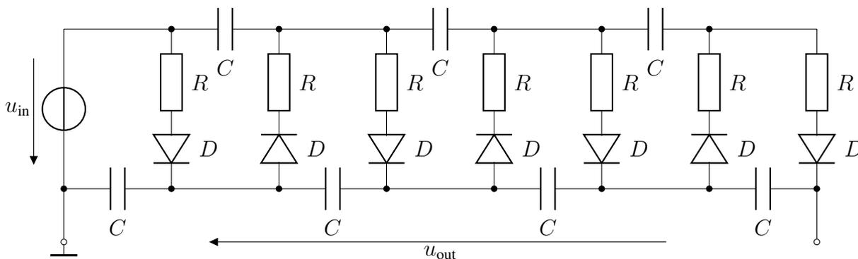
Abbildung 12.6: Spannungsvervielfacher
