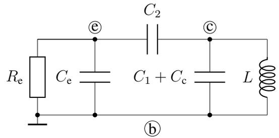
Abbildung L14.13: Sperrbereich, Kleinsignal
