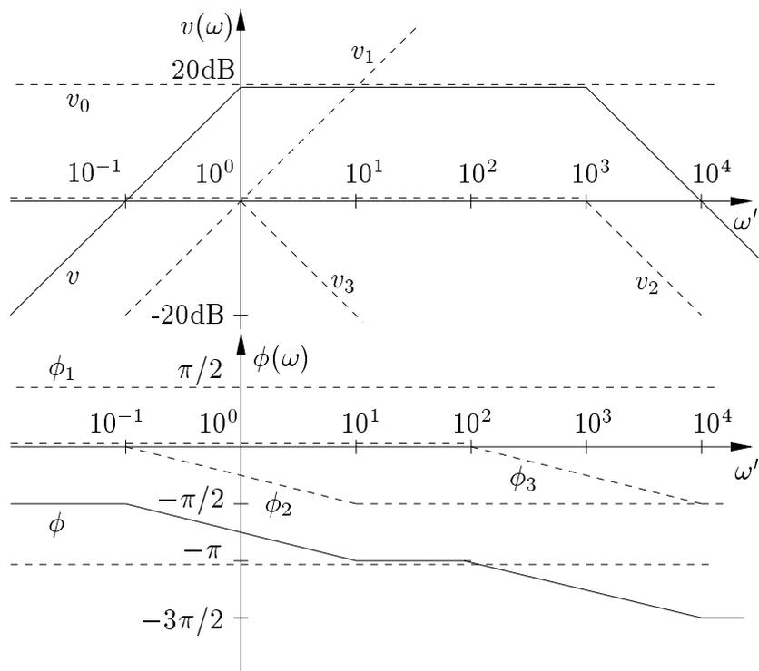
Abbildung L16.7: zu L16.5 c: Betrags- und Phasenverlauf, schematisch
