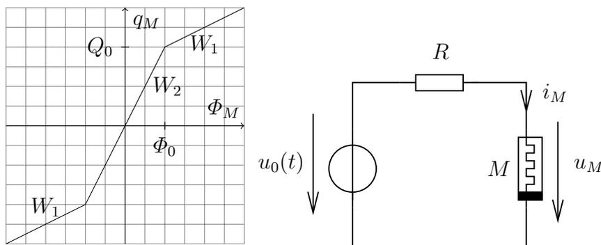
Abbildung 12.19: Kennlinie des Memristors und Schaltung mit Memristor
