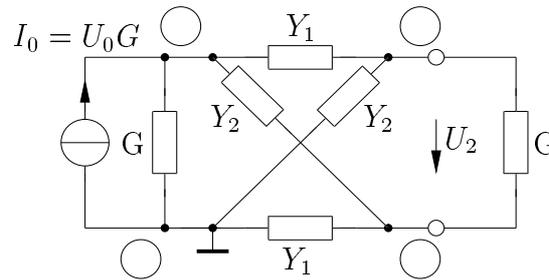
Abbildung L16.20: zu L16.10, Kreuzglied, Spannungsquelle in Stromquelle gewandelt
