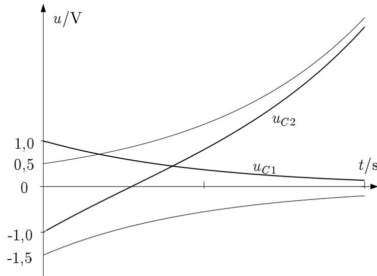
Abbildung L13.18: Zeitverlaufverlauf  $u_{C1}(t)$ ,  $u_{C2}(t)$
