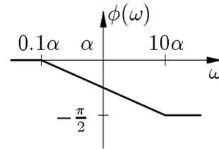
Abbildung L16.15: Phase von  $H_1(j\omega)$
