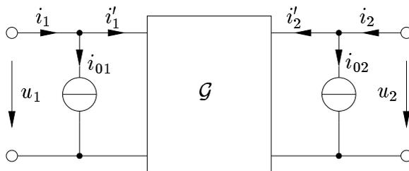
Abbildung L13.11: zu L13.5, 2. Schritt, Leitwertmatrix
