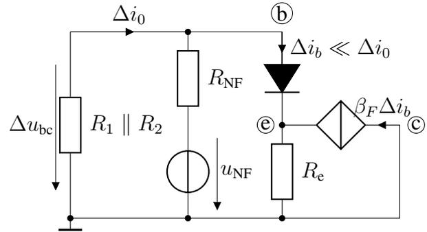
Abbildung L14.17: Modell für den NF Bereich
