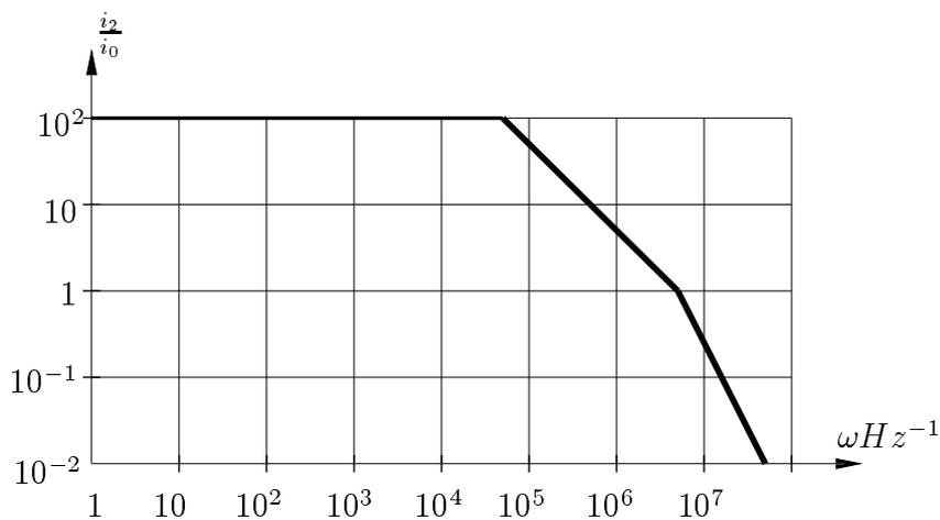
Abbildung L17.8: zu L17.2 g, Frequenzgang der Kleinsignalstromverstärkung
