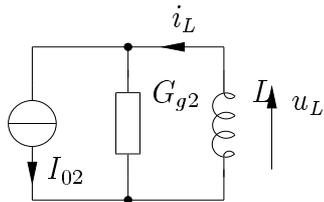
Abbildung L12.25: zu L12.10: ESB für geschlossenen Schalter S
