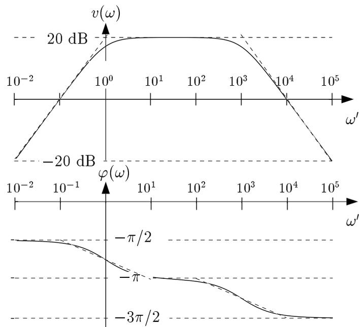
Abbildung L16.8: zu L16.5 d: Betrags- und Phasenverlauf, tatsächlicher Verlauf
