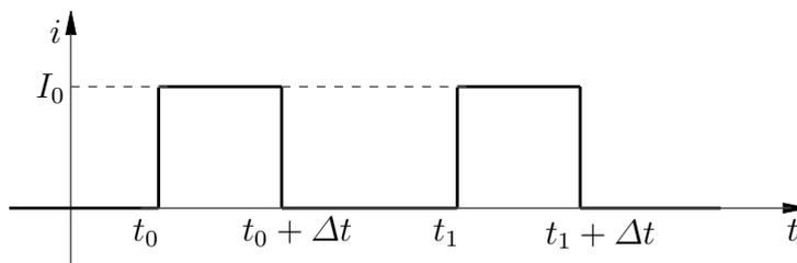
Abbildung 11.8: Strom durch den Memristor
