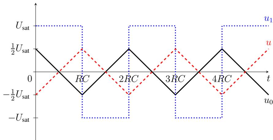
Abbildung L12.46:  $u$ ,  $u_0 = -u$  und  $u_1$  am Funktionsgenerator für  $R_1 \rightarrow \infty$ ,  $R \neq 0$
