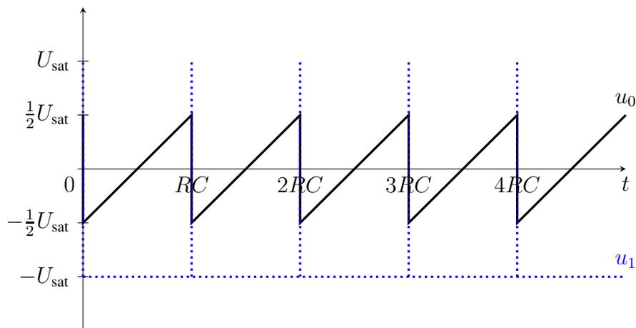
Abbildung L12.47:  $u_0 = -u$  und  $u_1$  am Funktionsgenerator für  $R_1 \rightarrow 0$ ,  $R \neq 0$
