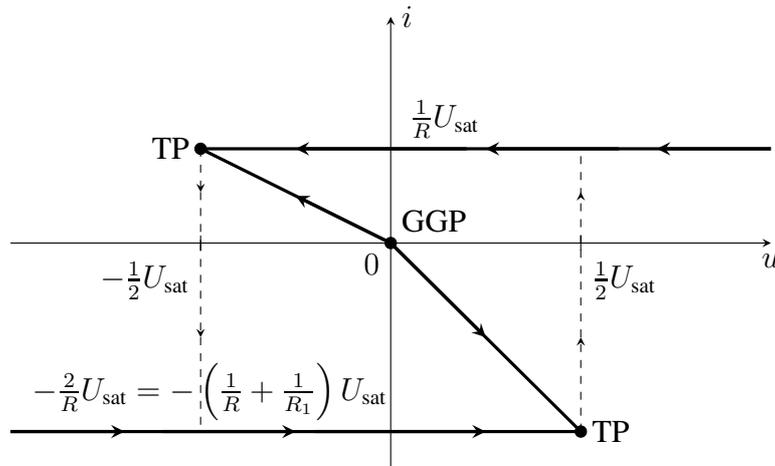
Abbildung L12.45: Dynamischer Pfad an der Funktionsgeneratorschaltung für  $R = R_1 \neq 0$
