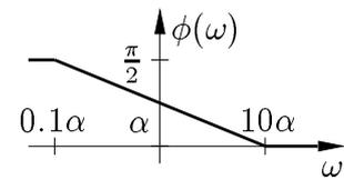
Abbildung L16.17: Phase von  $H_2(j\omega)$
