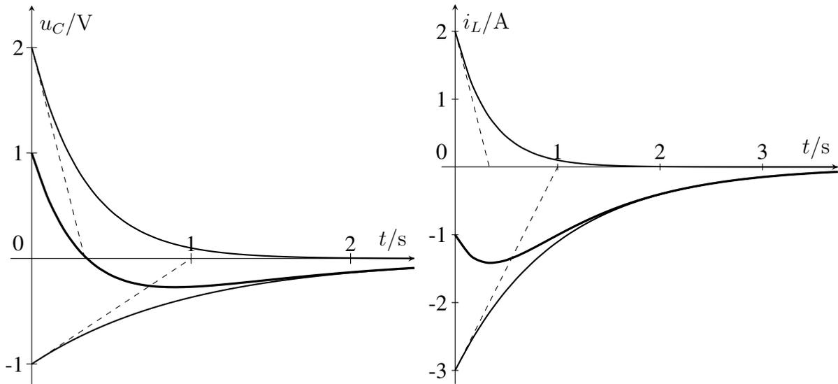
Abbildung L13.20: zu L13.10 b: Zeitverlaufverlauf  $u_C(t)$ ,  $i_L(t)$ , Summenkurve fett
