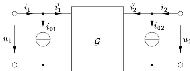
Abbildung L13.2: zu L13.1 Schritt 2, Ersatzschaltbild: Leitwertmatrix
