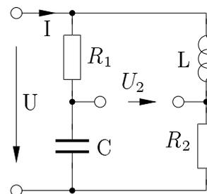
Abbildung 16.2: Schaltung zur komplexen Wechselstromrechnung (B)
