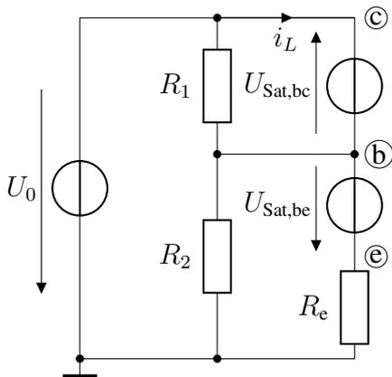
Abbildung L14.14: Sättigung, Großsignal
