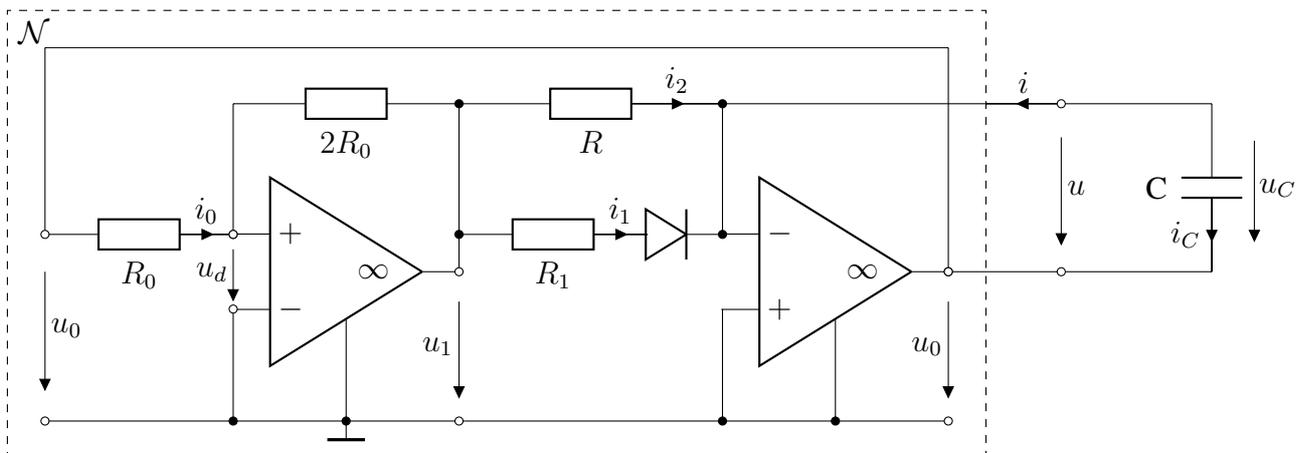
Abbildung 12.16: Funktionsgenerator
