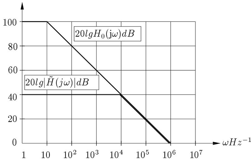
Abbildung L17.3: zu L17.1 d und L17.1 e, Bodediagramm, Beträge der Übertragungsfunktionen
