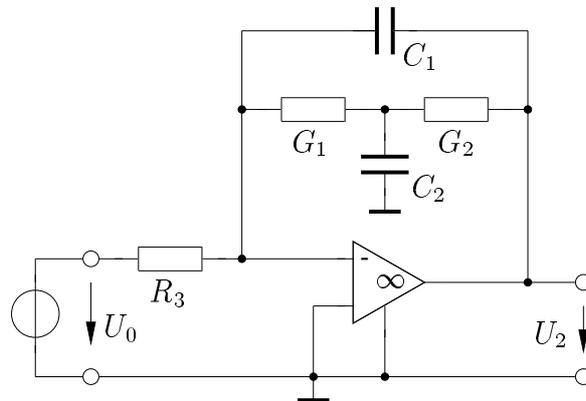
Abbildung 16.8: zu 16.7 c: Überbrücktes RC-Glied als Rückkopplung
