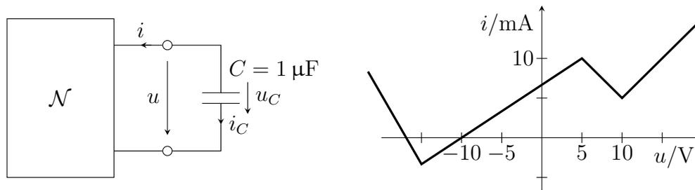
Abbildung 12.11: zu 12.11: Zweipol  $\mathcal{N}$  mit Kapazität
