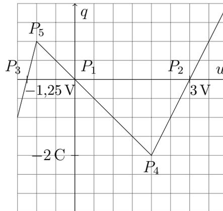
Abbildung L11.19: zu L11.8 g: Kennlinie und Relaxationspunkte
