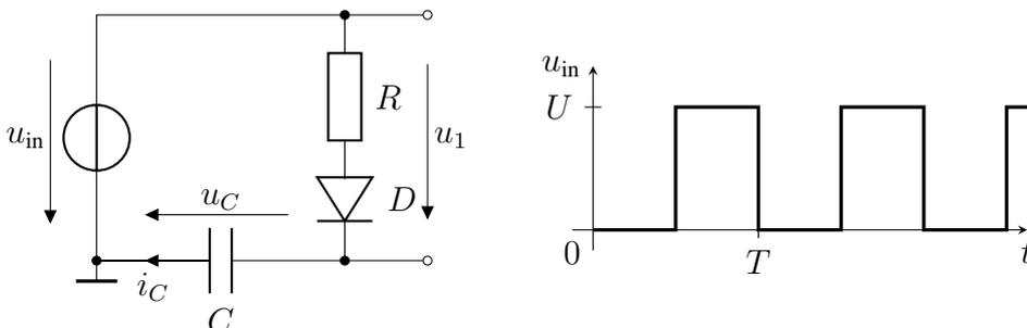
Abbildung 12.5: Stückweise konstante Erregung
