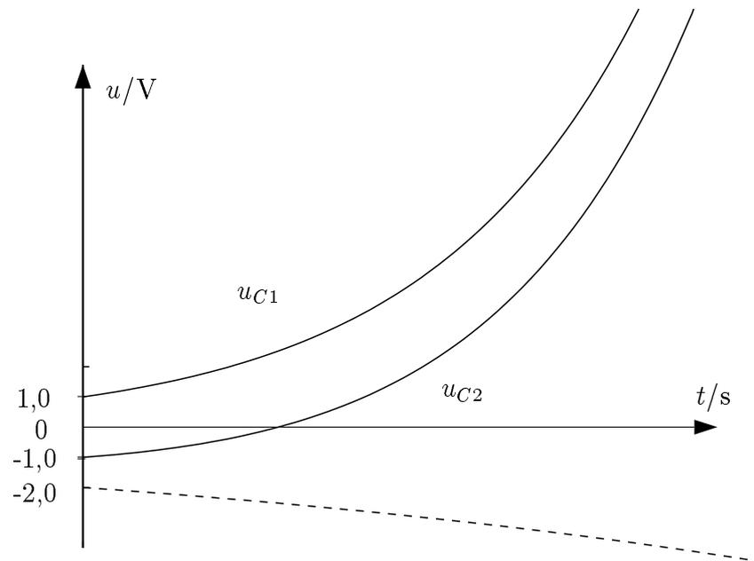
Abbildung L13.16: Zeitverlauf  $u_{C1}(t)$ ,  $u_{C2}(t)$
