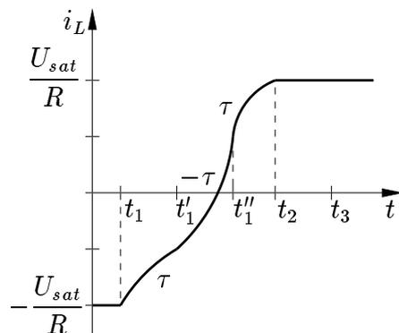
Abbildung L12.55: zu L12.17i: Stromverlauf  $i_L(t)$
