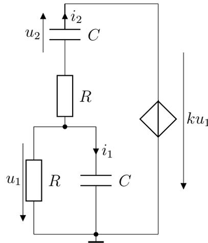
Abbildung L13.32: ESB: Wien-Robinson-Oszillator mit OpAmp im streng linearen Bereich
