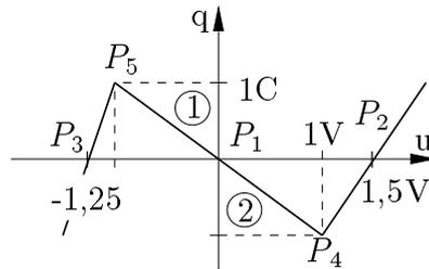
Abbildung L11.18: zu L11.8 d und f: Kennlinie und Relaxationspunkte
