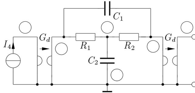
Abbildung L16.12: zu L16.7 a, Überbrücktes RC-Glied mit Gyrotoren
