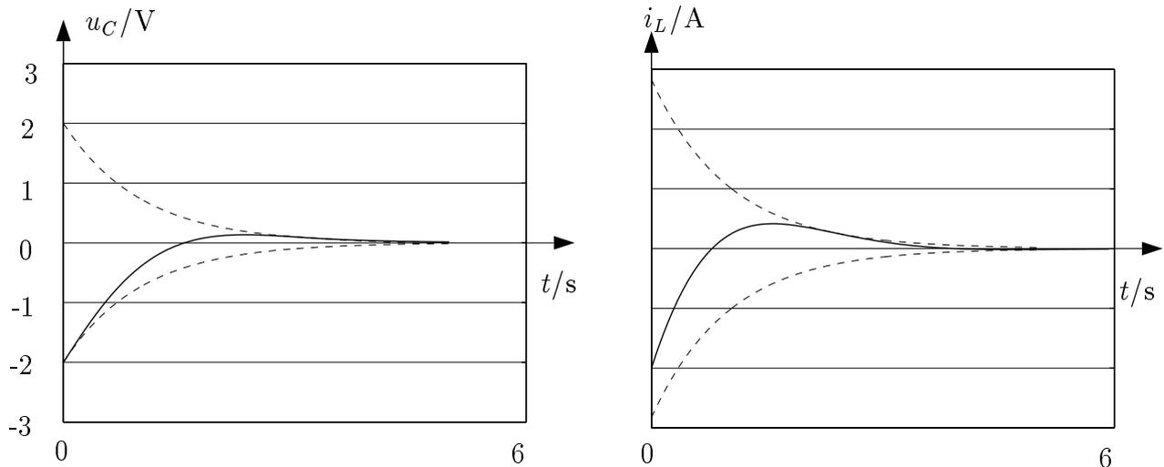
Abbildung L13.28: zu L13.10 j; Zeitverlauf von  $u_C$  und  $i_L$
