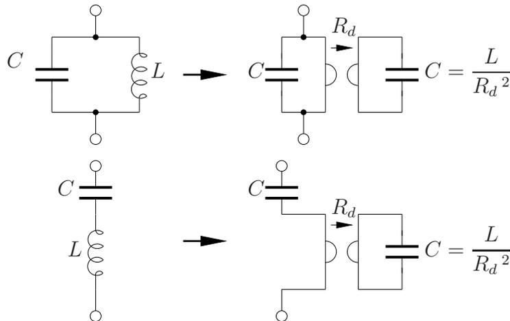
Abbildung L11.12: Parallelschwingkreis bzw. Serienschwingkreis
