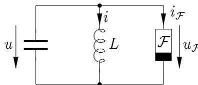
Abbildung 14.3: Van der Pol-Oszillator
