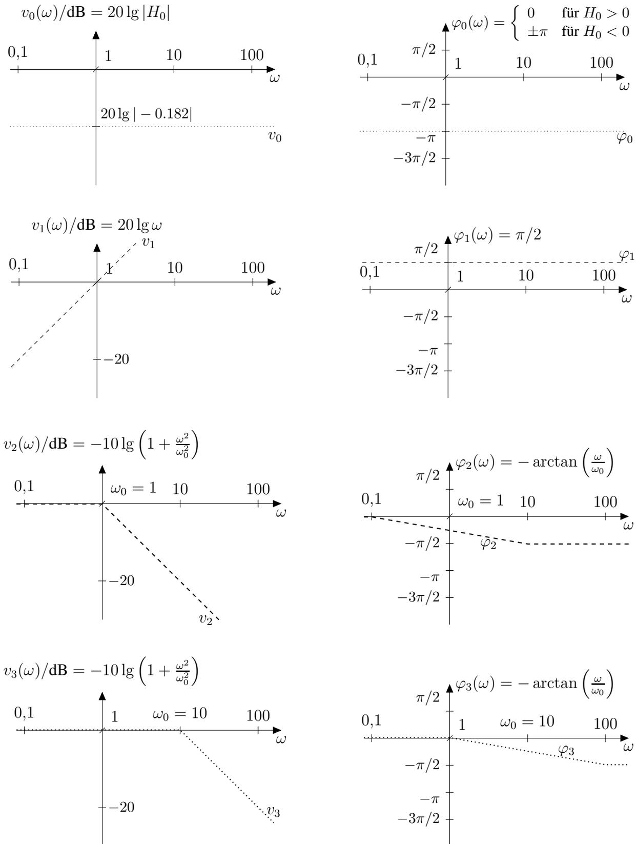
Abbildung L16.6: zu 16.4 c: vier Teile der Übertragungsfunktion
