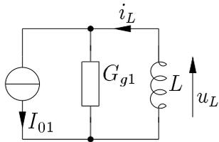
Abbildung L12.24: zu L12.10: ESB für geöffneten Schalter S
