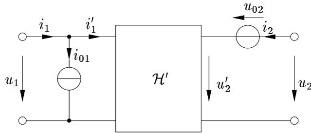
Abbildung L13.6: zu Schritt 2, Ersatzschaltbild: inverse Hybridmatrix
