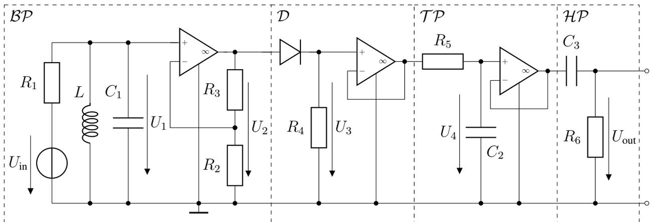
Abbildung 16.12: Detektorempfängerschaltung
