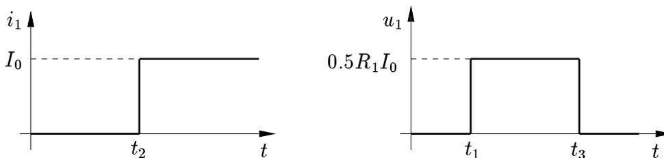
Abbildung 12.2: zu 12.1 d: Stückweise konstante Erregung
