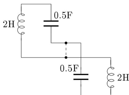
Abbildung L15.1: zu L15.2 b Kopplung der Schwingkreise, gegenphasige Schwingung
