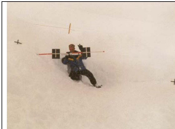
Abb. 16: Kalibrierung der Videokameras
