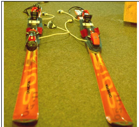
Abb. 8: Testski Atomic mit Meßbindung
