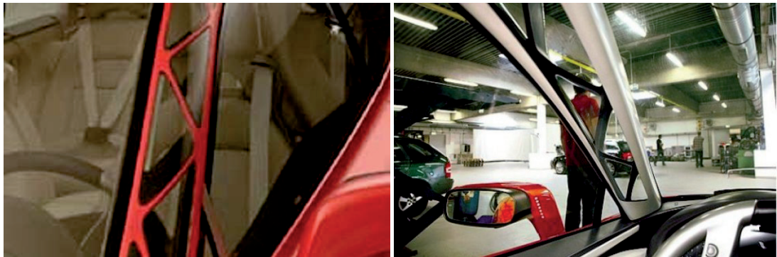
Abbildungen 5-47 und 5-48: A-Säule mit Fachwerk-Struktur im Volvo Safety Concept Car (linkes Bild: von außen, rechtes Bild: Sicht von innen)
