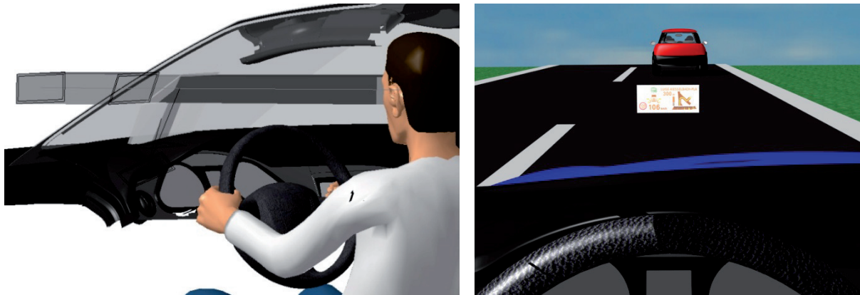
Abbildungen 4-17 (links) und 4-18 (rechts): Auslegung eines Head Up Displays (HUD), links: Strahlengangsanalyse, rechts: Bildposition aus der Fahrersicht
