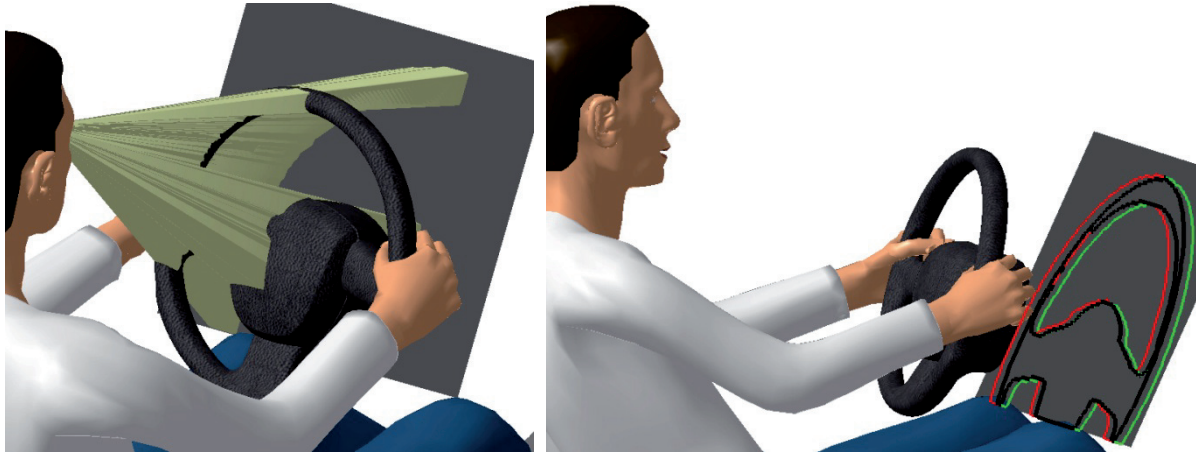
Abbildungen 4-14 (links) und 4-15 (rechts): Analyse des Sichtschattens des Lenkrades für die Sicht auf das Kombiinstrument: links: halbseitige Darstellung der abgeschatteten Sichtstrahlen, rechts: Darstellung der monokularen und binokularen Sichtgrenzen auf der Zifferblattebene → ‚Lenkradbahnane‘
