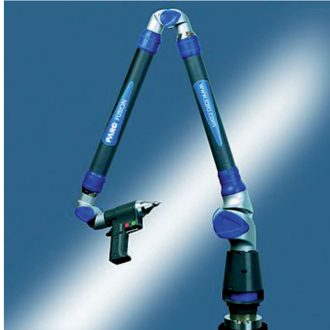
Abbildung 6-2: FARO-3D-Koordinaten-Messarm (Quelle: FARO)
