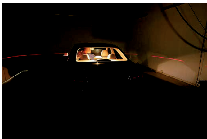
Abbildungen 3-16 und 3-17: links: SAE-Hüftpunktmessmaschine mit Lasertheodolit-Aufsatz zur Sichtfeldvermessung (Quelle: Department of Transport) rechts: Lasermarkierungen der unverdeckten Bereiche im Messraum
