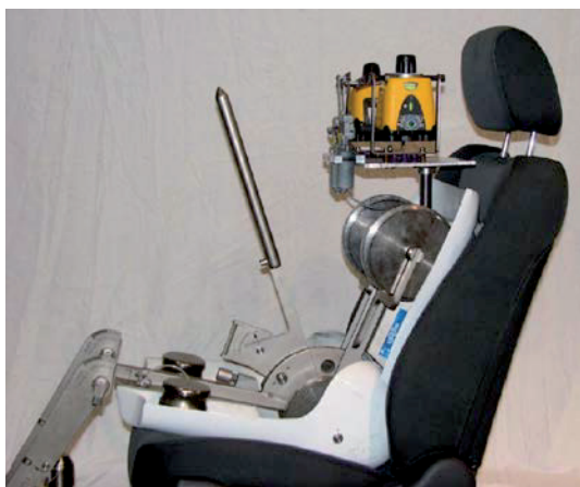
Abbildungen 3-16 und 3-17: links: SAE-Hüftpunktmessmaschine mit Lasertheodolit-Aufsatz zur Sichtfeldvermessung (Quelle: Department of Transport) rechts: Lasermarkierungen der unverdeckten Bereiche im Messraum
