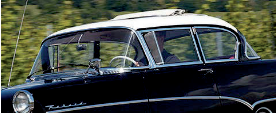
Abbildung 5-46: Großes unverdecktes Fahrersichtfeld durch eine ‚Panorama‘-Windschutzscheibe im Opel Rekord P1 von 1958 (Quelle: Auto-Motor-Sport)
