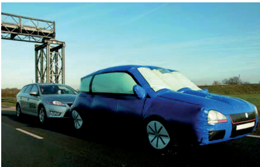
Abbildung 6-44: ‚Soft Target‘, ein antriebener Luftsack in Gestalt eines Fahrzeugs zur gefahrlosen Erprobung von Fahrerassistenzsystemen auf Teststrecken, wäre auch für Fahrsicherheitstrainings mit Kollisionsgefahr sinnvoll einsetzbar (Quelle: the Engineer)
