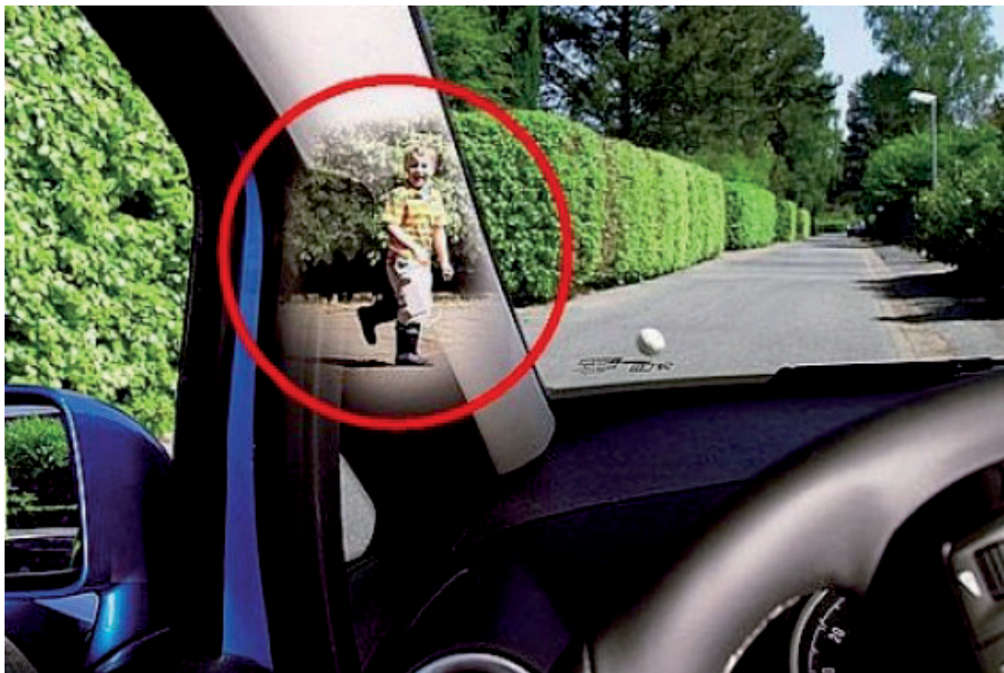
Abbildung 3-10: Fotomontage einer Sichtverdeckungssituation durch eine breite A-Säule (Quelle: AutoBild)
