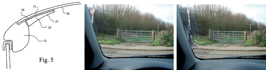
Abbildung 5-49: Prismenlinse im Horizontalschnitt (links), Fahrersicht ohne (Mitte) und mit Prismenlinse (rechts) (Quellen: US Patent 7475932, MIRA 2007)
