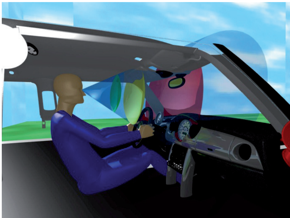
Abbildungen 4-10 (oben) und 4-11 (unten): Mindestsehentfernungen im Fahrzeug: oben: altersbedingter Akkomodationsverlust; unten: Distanzen im Fahrzeug für 50-jährigen mittelgroßen Fahrer
