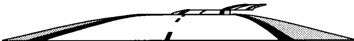
Abbildung 2-9: Abtauchen der Straße in Senken (Quelle: Heise, 2003)
