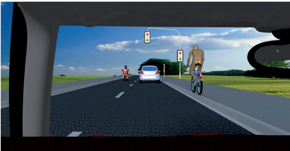
Abbildung 4-26: Parametrisch einstellbare Verkehrssituation mit Verkehrsteilnehmern und -objekten zur Sichtanalyse mit 3D-CAD-Geometrie
