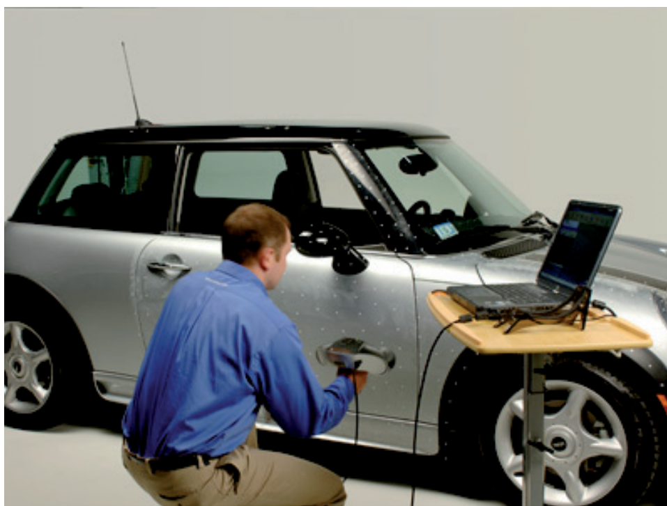
Abbildung 3-20: 3D-Scan einer Fahrzeugkarosserie (Quelle: EMS-USA)
