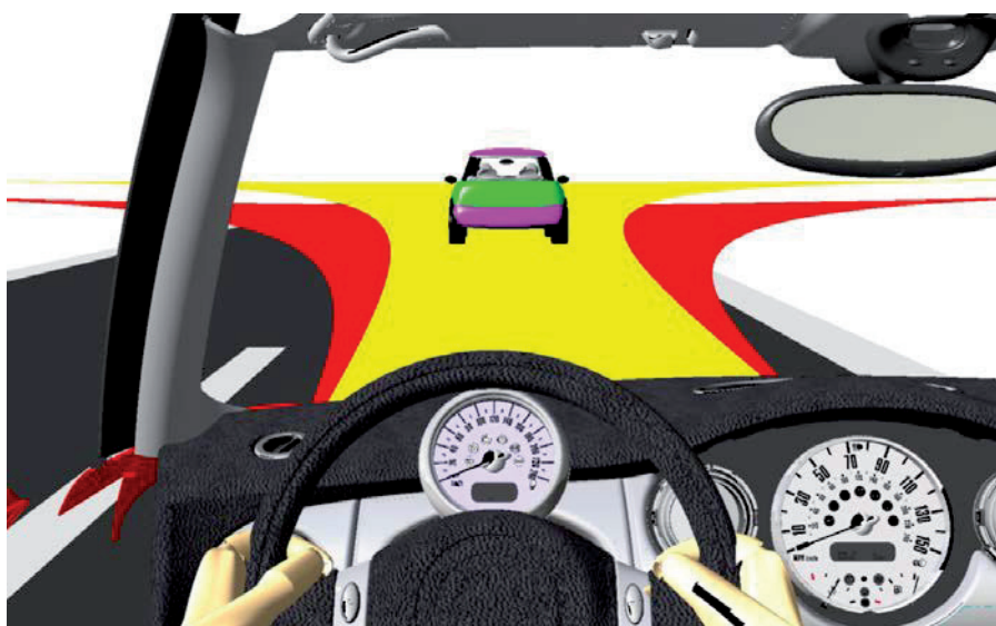
Abbildung 4-26: ‚Hirschgeweih‘ aus 100km/h jeweils für 0,9g und 0,3g Gesamtbeschleunigung (Fahrersicht)
