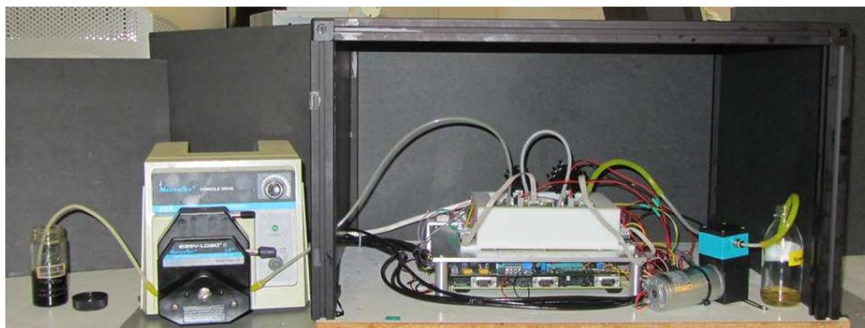
**Abbildung 5.14** Messaufbau zur Probenmessung in Transmission in den Spektralbereichen NIR und MIR.
