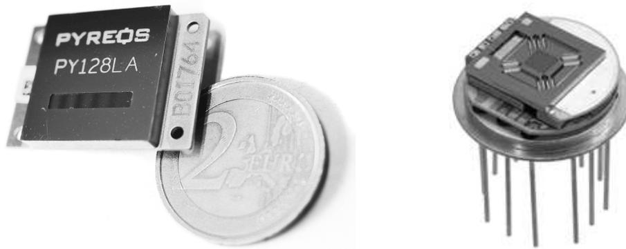
**Abbildung 2.14** Im linken Bild ist ein LWF, integriert in einen pyroelektrischen Zeilendetektor der Firma *Pyreos* abgebildet. Die rechte Abbildung zeigt den verstimmbaren Fabry-Pérot-Filter der Firma *InfraTec* [143].
