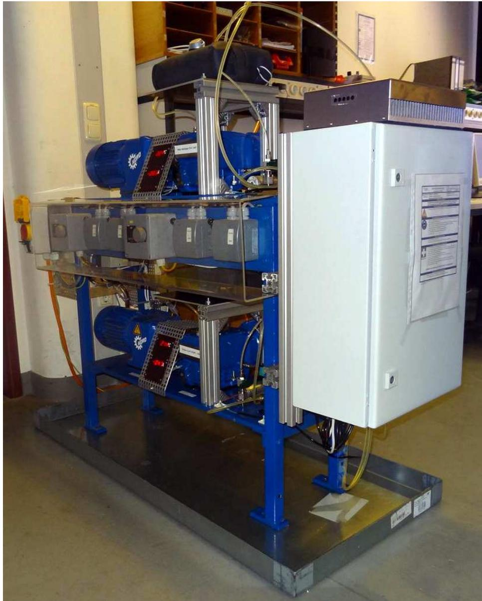
**Abbildung 6.1** Prüfstand zur zeitlich hoch aufgelösten Erfassung der Ölalterung.
