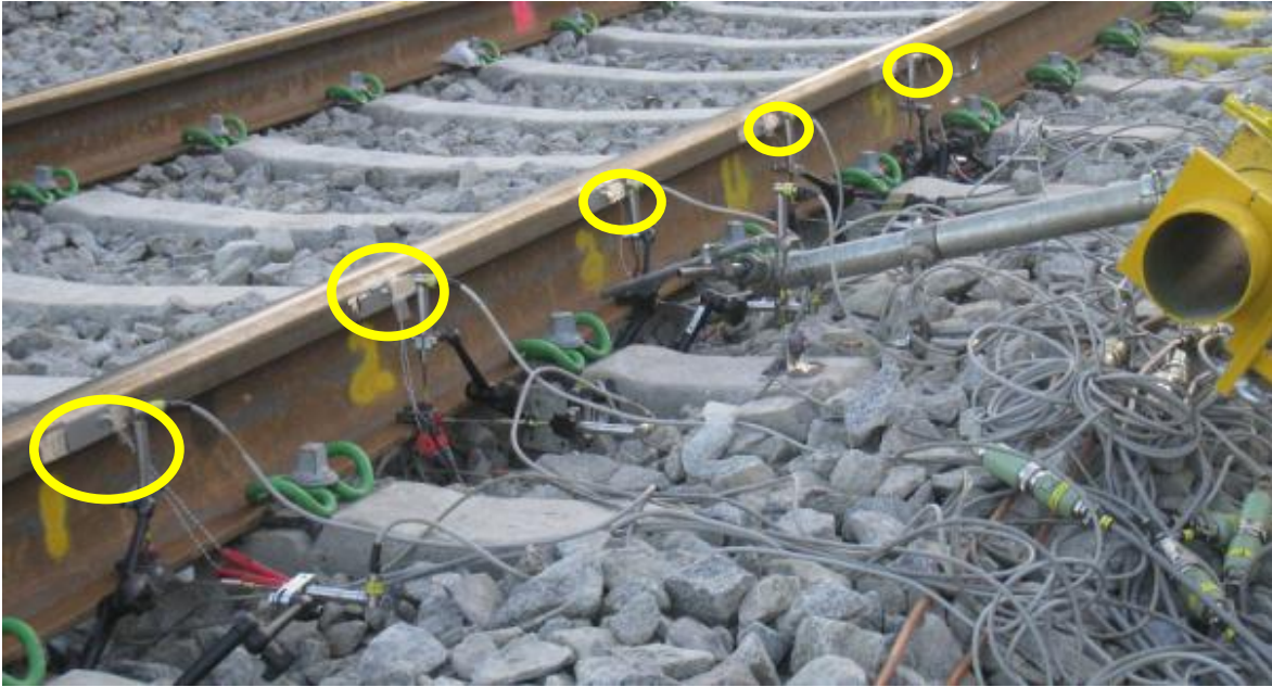
Bild. A. 7: 5 Dehnmessstreifen am Schienenkopf (DMS2)
