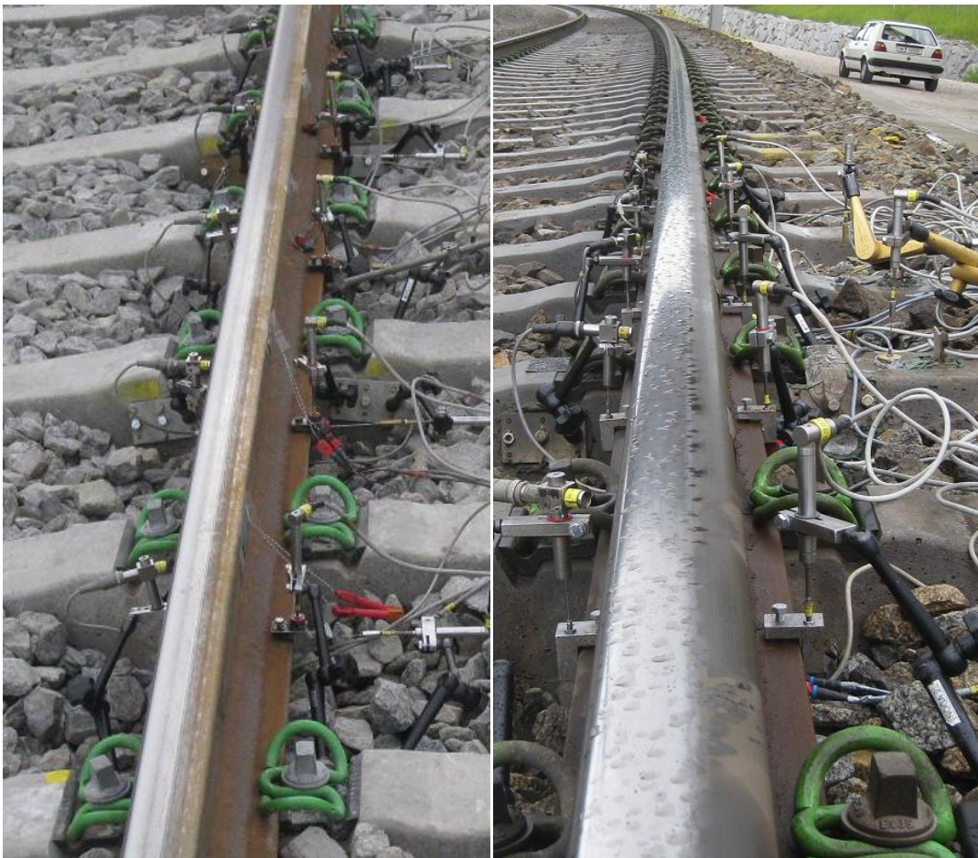
Bild. A. 8: Messkette bestehend aus 5 benachbarten Messquerschnitten – links: 1.FM; rechts: 3.FM.
