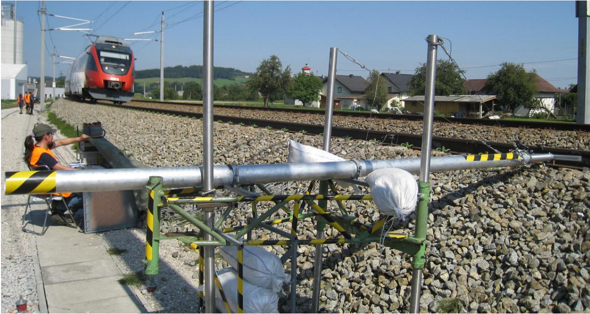
Bild. A. 11: Mobile Messbasis zum Messen der absoluten Einsenkung der Schwelle
