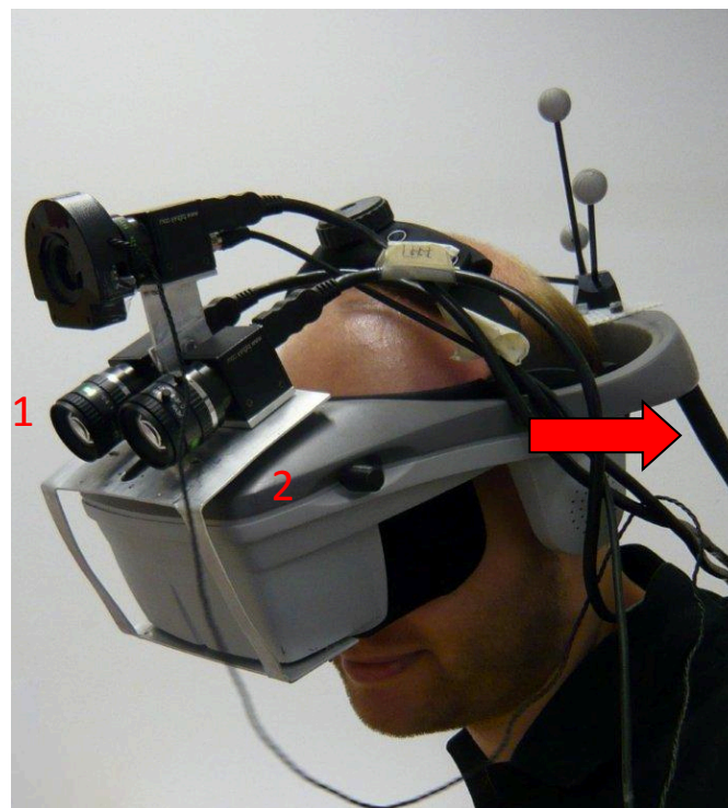
Abbildung 8: „Head-mounted display“ mit den zwei Kameras (1), der Halterung mit Displays (2), sowie dem Datenkabel (Pfeil).
