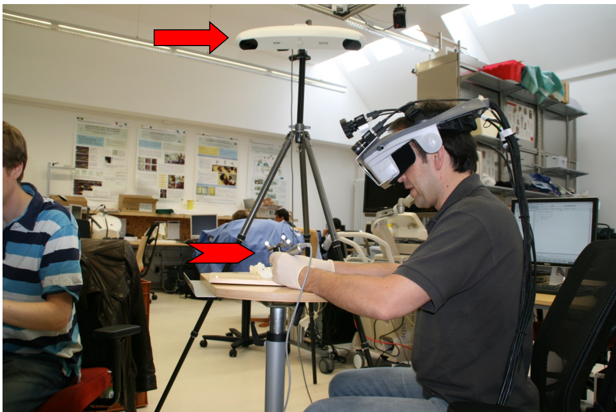
Abbildung 7: Experimenteller Aufbau im Labor. Zu sehen ist ein Proband bei Durchführung der Bohrung mit HMD (Pfeilspitze). Der Pfeil deutet auf die Infrarotkamera von NDI®.
