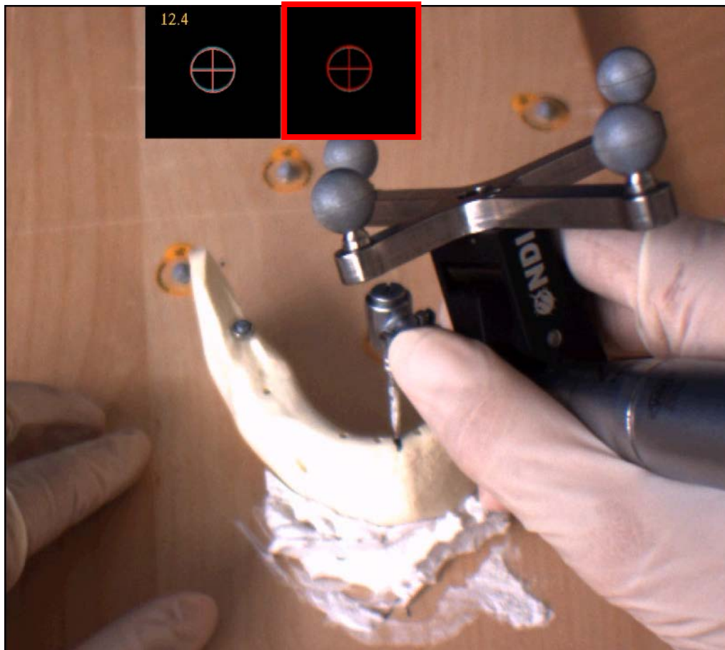
Abbildung 12: Bohrung des Kanals. Sobald sich auch das rechte Paar Fadenkreuze überlappte (roter Kasten), konnte man die Bohrung beginnen.
