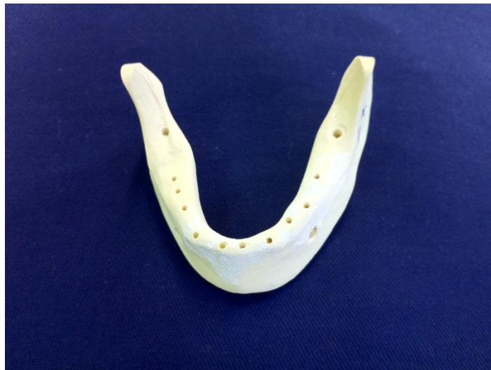
Abbildung 4: Plastikkiefer nach Durchführung der Versuche. Es befinden zehne Bohrlocher im anterioren bis mittleren Bereich des Corpus mandibulae. Die zwei posterioren, großlumigen Kanäle dienen der Montage auf den Spanholzplatten mittels zweier Schrauben.
