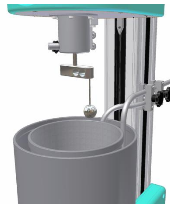
Bild 117: Rheometer mit Kugelgeometrie zur Bestimmung von statischer Fließgrenze und Thixotropie (Fa. Schleibinger)
