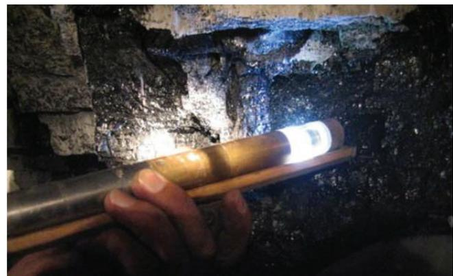
Abb. 5: SlimBoreholeScanner (SBS) entwickelt von DMT.
