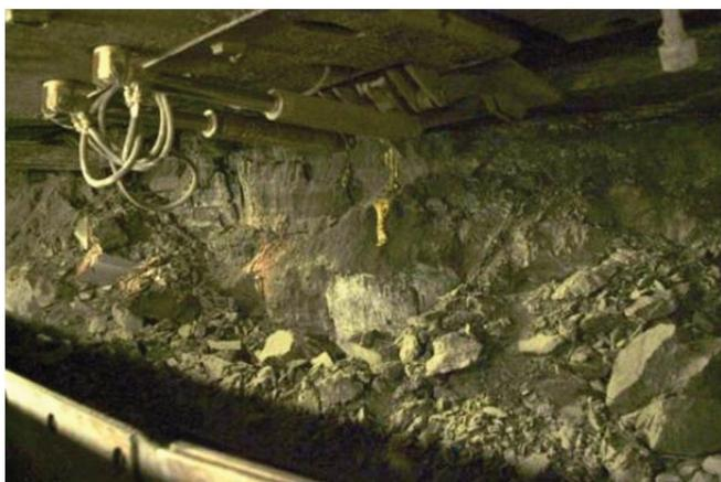
Abb. 1: Unerwünschter Mehrausbruch im Hangenden eines Kohlenflözes.
