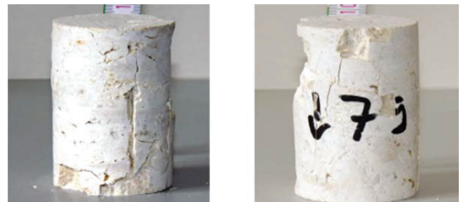
Abb. 3: Bruchformen nach einaxialem Druckversuch, Kehlheimer Kalk B. 3-1-A, PK 79
