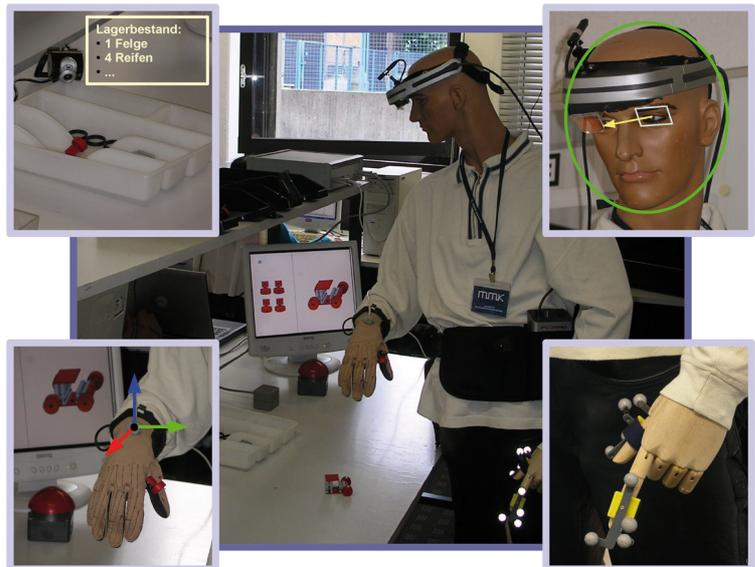
**Bild 3. Beispielhafte multimodale sensortechnische Erfassung: visuelle Überwachung der Bauteilentnahme (links oben); Hand- und Fingerverfolgung über einen Datenhandschuh (links unten) sowie über markerbasiertes Infrarottracking (rechts unten); Gesichts- und Emotionserkennung (rechts oben)**
