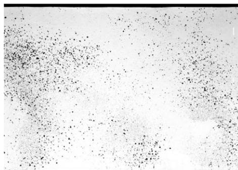
Abb. A8: Ergebnisse der Flächenapplikation mit Doppelflachstrahl Düsen (DF)
